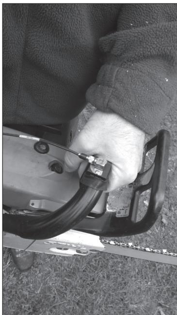
Slika 4. Montaža akcelerometra na motornu pilu
