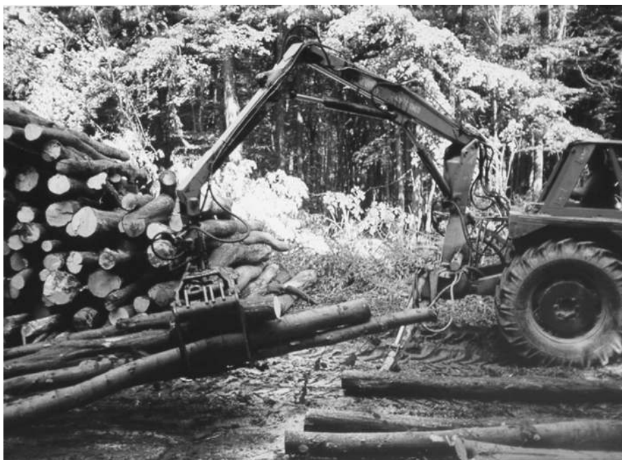
Slika 1. Traktor s dizalicom pri slaganju višemetarskoga drva na pomoćnom stovarištu
