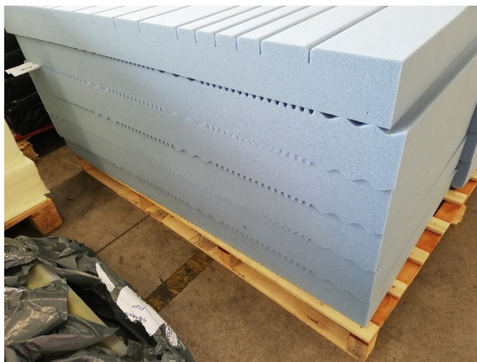
Slika 46. Profilirane jezgre Modela C
