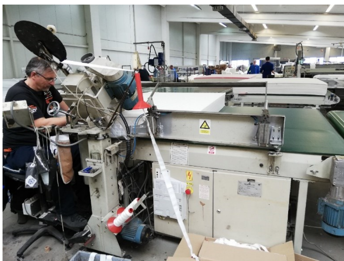
Slika 19. Šivanje rubova navlake pomoću tape-edge šivaćeg stroja
