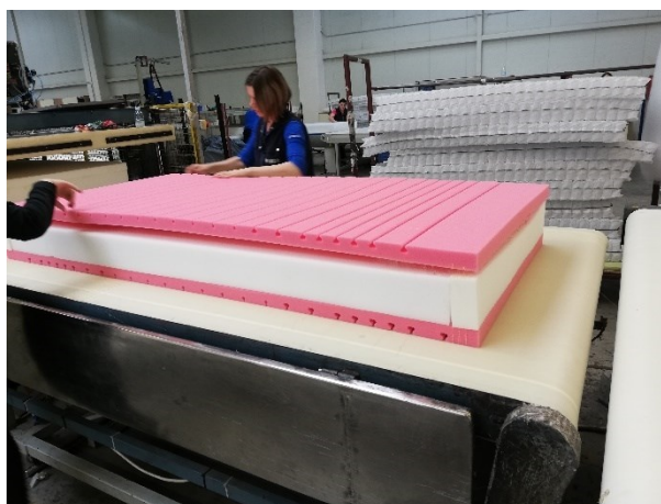
Slika 36. Preklapanje jezgre s oblogom
