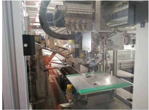
Slika 10. Okomiti stroj za obradu rubova
