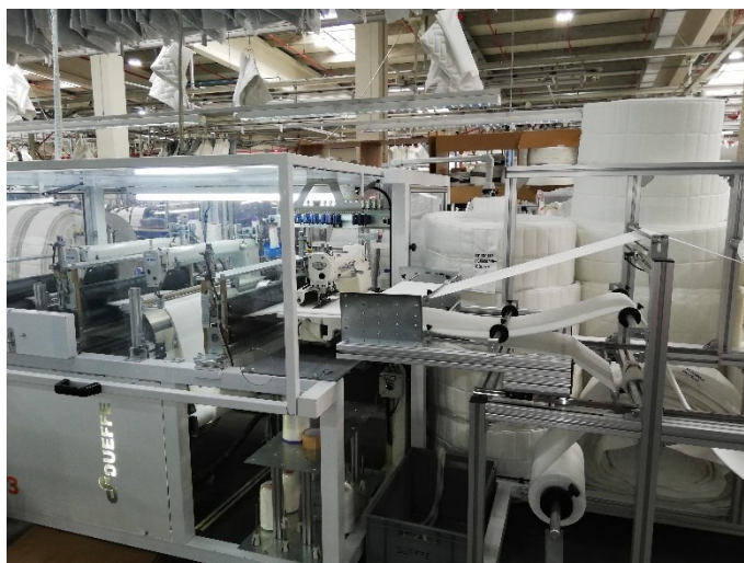
Slika 21. Stroj za šivanje bordera
