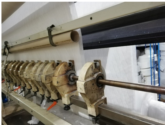
Slika 5. Krojenje rubne plohe pomoću noževa na stroju Foto: N. Klarić, 2021.
