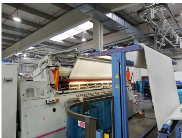
Slika 25. Šivanje ploha na višeglenom šivaćem stroju
