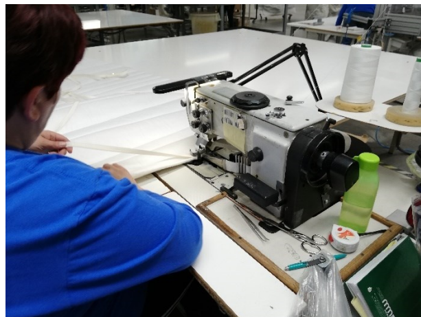
Slika 28. Šivanje patentnog zatvarača na donju plohu navlake
