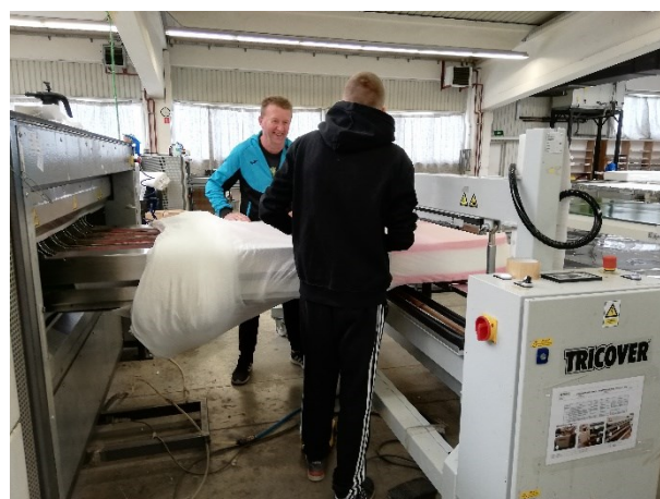
b) navlačenje triko navlake
