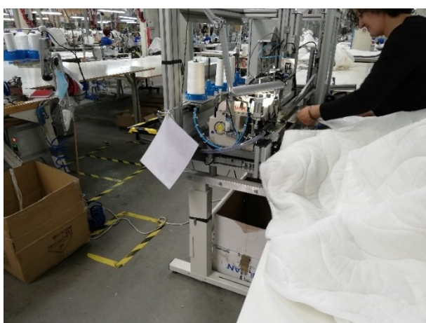
Slika 44. Stroj za izradu uglova
