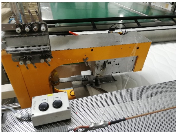
Slika 42. Paralelni stroj za obamitanje
