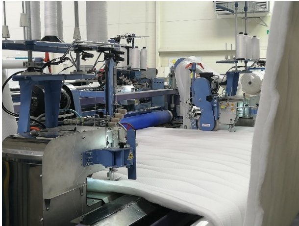
Slika 9. Set paralelnih strojeva za obradu ruba
