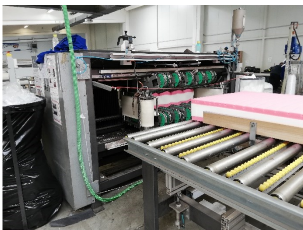
a) uvlačenje rohlinga u stroj
