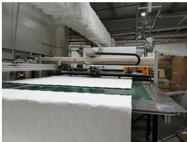
Slika 43. Okomiti stroj za obamitanje
