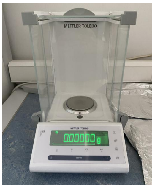
Slika 4. Analitička vaga Mettler Toledo
