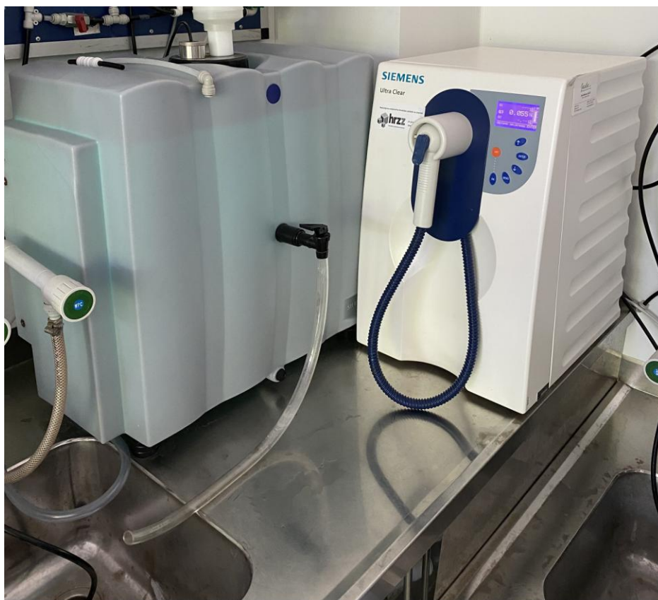
Slika 1. Siemens Ultra clear - uređaj za pročišćivanje vode
