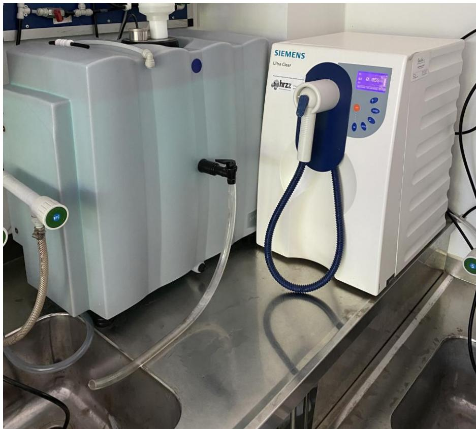
**Slika 1.** Siemens Ultra clear - uređaj za pročišćivanje vode
