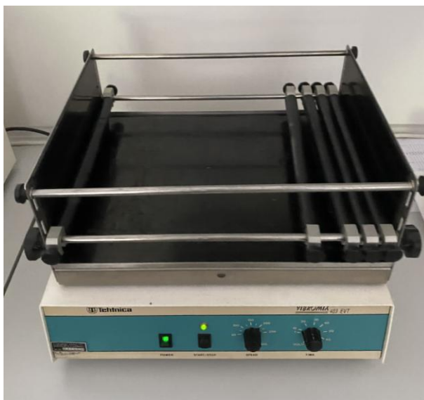
Slika 2. Tresilica Tehnica Vibromix 403 EVT
