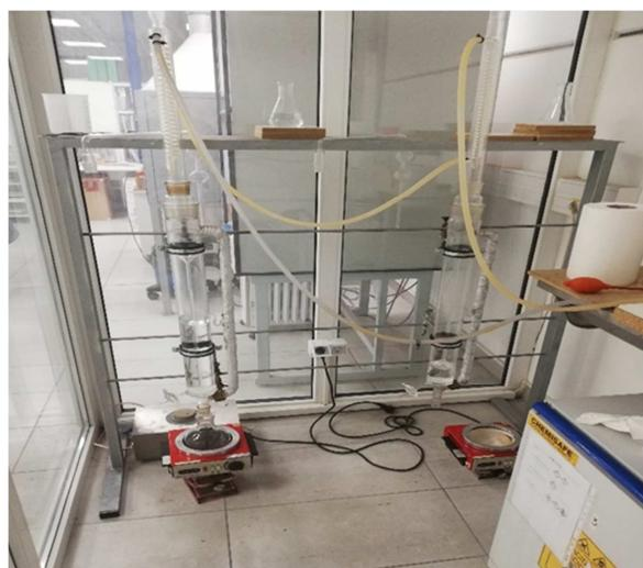
*Slika 7. Perforatorska metoda ispitivanja*
