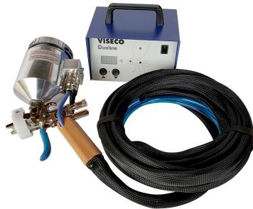
Slika 15. Uređaj s pištoljem za vruće štrcanje voska
