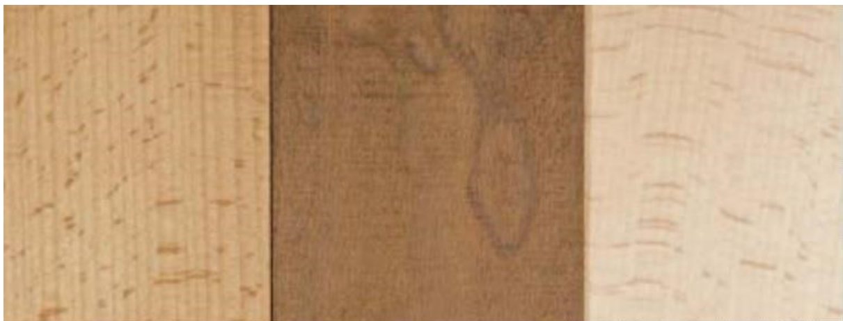
Slika 21. Prirodna bukovina (desno) i toplinski obrađena bukovina pri različitim temperaturama (lijevo i u sredini) (foto: Turkulin)
