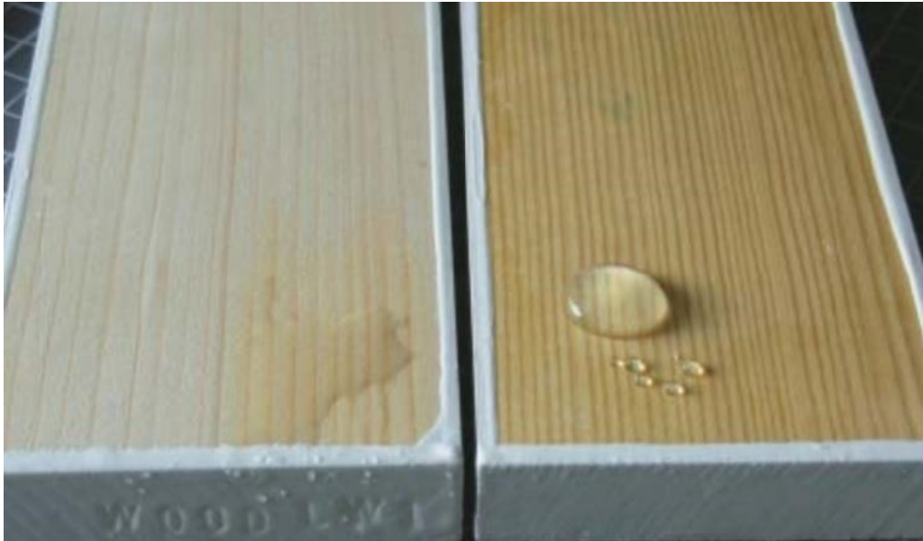
Slika 24. Povećanje hidrofobnosti drva obrađenog hidrofobnim impregnacijskim sredstvom (desno) u usporedbi s neobrađenim drvo (lijevo); ( foto: Turkulin )
