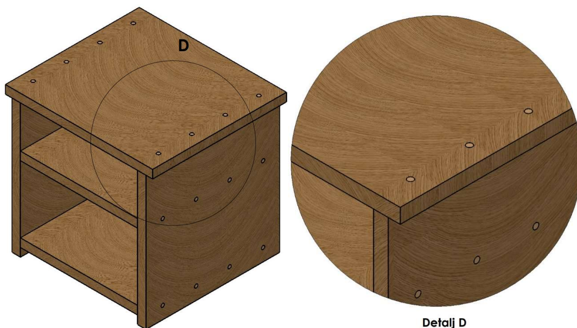
Slika 13. Vidljiv presjek moždanika na površini namještaja prilikom spajanja metodom rotacijskog zavarivanja
