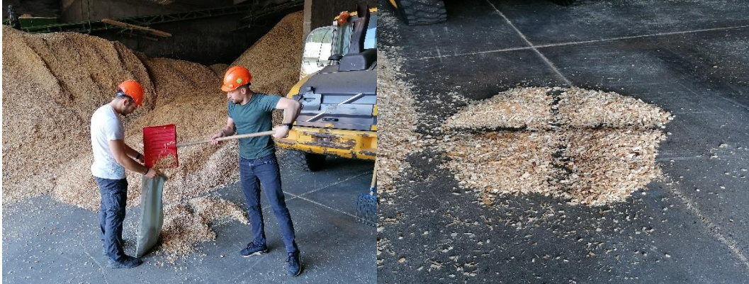
Slika 5. Uzorkovanje drvene sječke
