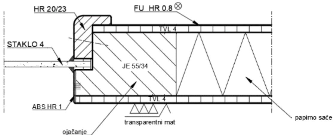
Slika 8. Staklena uklada u poluutoru učvršćena letvicom
