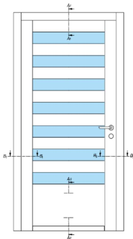
Slika 34. Nacrt vrata sa naznačenim karakterističnim presjecima
