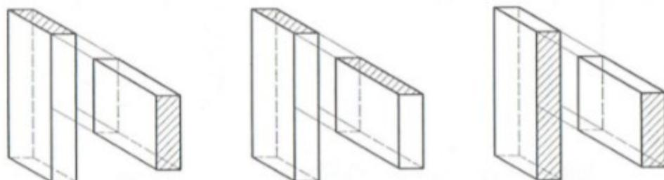
Slika 22. Položaj dijelova kod ugaono bočnog sastavljanja (a) bočni i čeonu rub, (b) bočni rubovi, (c) čone rubovi) (Tkalec i Prekrat, 2000.)
