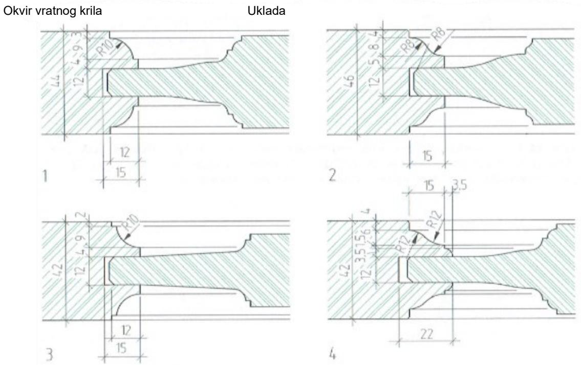
Slika 11. Drvene profilirane uklade ugrađene u utoru (Nutsch, 2012.)
