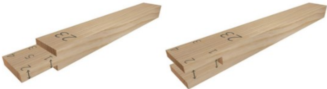
Slika 33. Prikaz ispitnih uzoraka (lijevo-čep, desno-raskol) i mjernih točaka (Elek i dr. 2020.)
