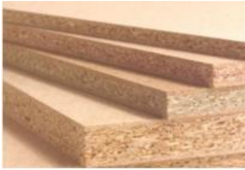
Slika 12 Troslojna ploča iverice s vodoravnim položajem mikro iverja
