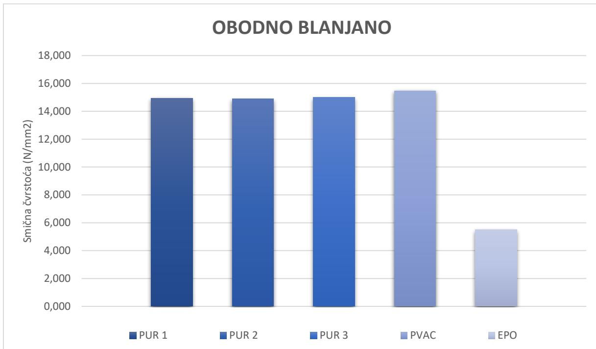
**Slika 11.** Grafički prikaz prosječne smične čvrstoće ( $N/mm^2$ ) uzorka obrađenih obodnim blanjanjem
