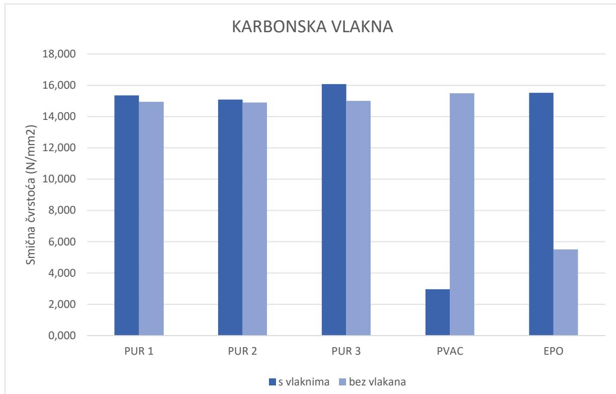
**Slika 12.** Grafički prikaz prosječne smične čvrstoće ( $N/mm^2$ ) uzorka sa umetnutim karbonskim vlaknima i referentnih uzorka
