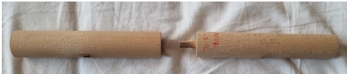
Slika 9. Elementi za dužinsko spajanje čepom pomoću rotacijskog zavarivanja (Župčić 2010)
