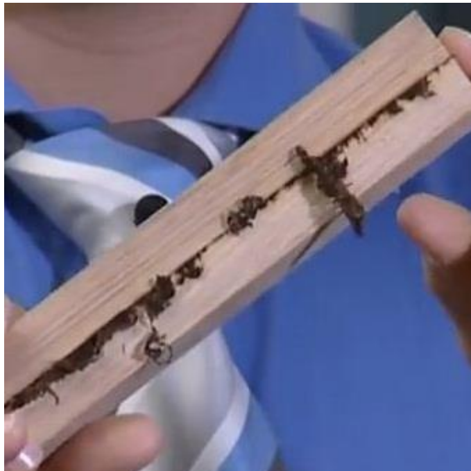
Slika 5. Dvije međusobno zavarene letvice linearno vibracijskom metodom (URL. 1)
