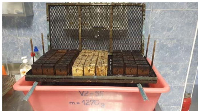
Slika 8. Kavez s uzorcima i posuda za uranjanje
