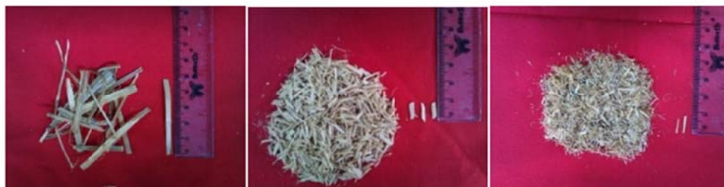
Slika 7. Čestice bambusa različitih veličina: a) vuna, b) srednja i c) fina granulacija (Izvor: Karlinasari i sur., 2012a)
