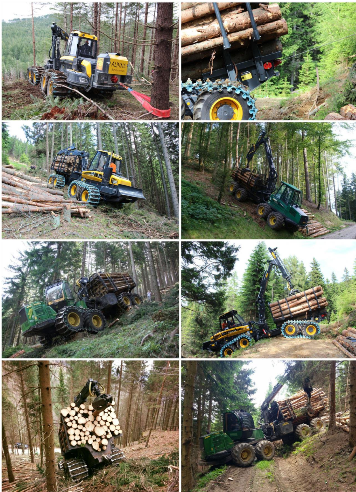
Slika 9. Forvarder sa sidreno – trakcijskim užem u radu
