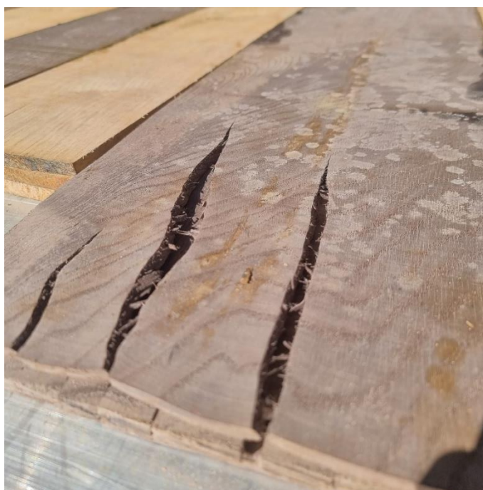
Slika 38. Čeone pukotine na uzorcima abonosa i gljive
