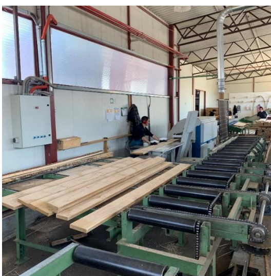
Slika 10. Obrada piljenica recentnog hrasta na optimizeru
