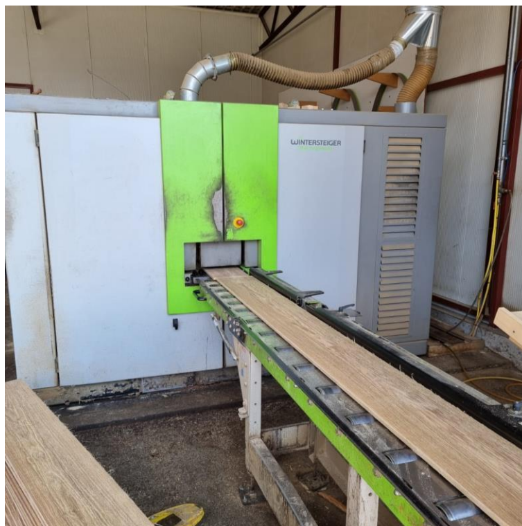
Slika 11. Obrada piljenica recentnog hrasta na fleksibilnoj tračnoj pili za tanko rezanje
