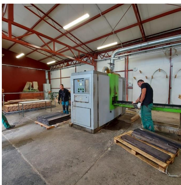
Slika 8. Obrada piljenica abonosa na fleksibilnoj tračnoj pili za tanko rezanje
