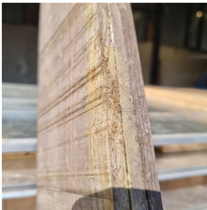
Slika 39. Plijesan na uzorcima abonosa
