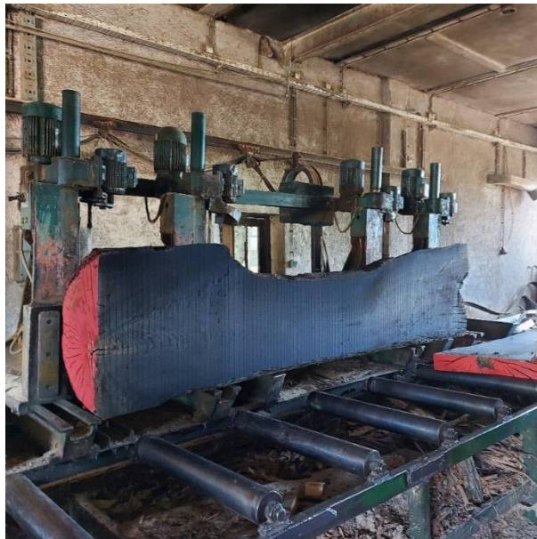
Slika 5. Raspiljivanje trupca abonosa na tračnoj pili trupčari
