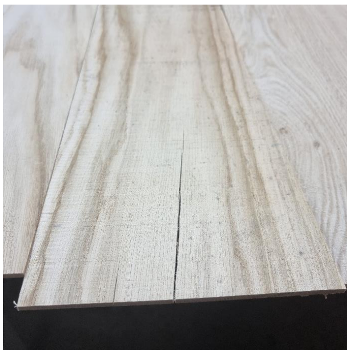
Slika 41. Čeona pukotina na uzorku recentnog hrasta
