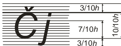
Slika 2.3 Dimenzije značajki tehničkoga pisma
