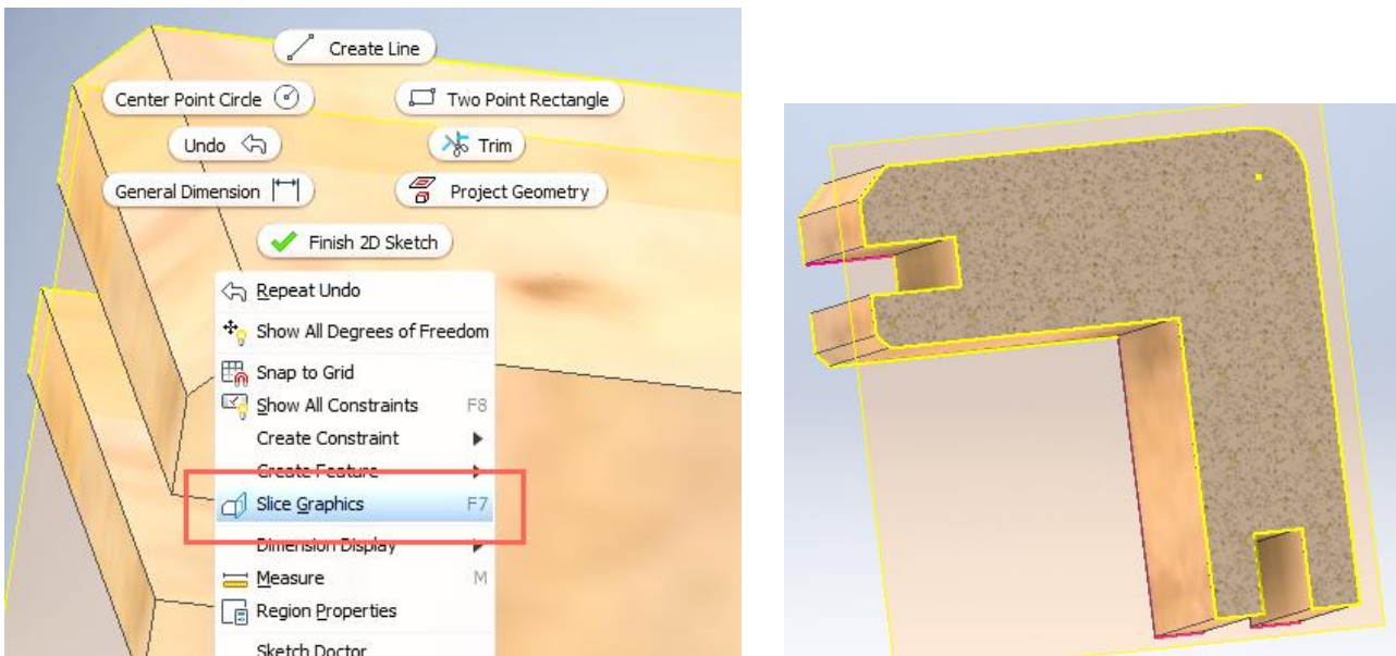
Slika 3.28 Odsijecanje dijela modela ravninom presijecanja primjenom opcije SliceGraphics
