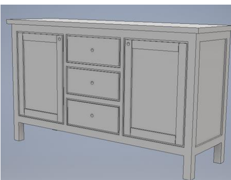
Slika 7.30 Provrti na prednjacima za učvršćenje prihvatnika
