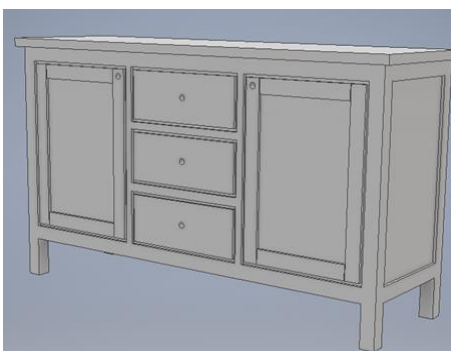
Slika 7.30 Provrti na prednjacima za učvršćenje prihvatnika
