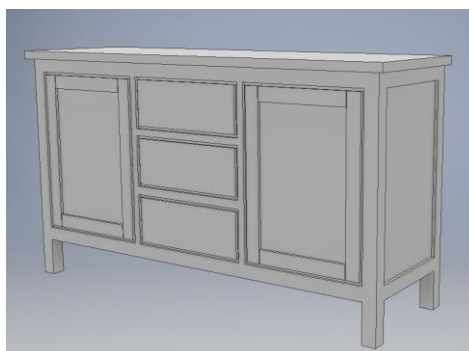
Slika 7.29 Strop komode izrađen ekstruzijom
