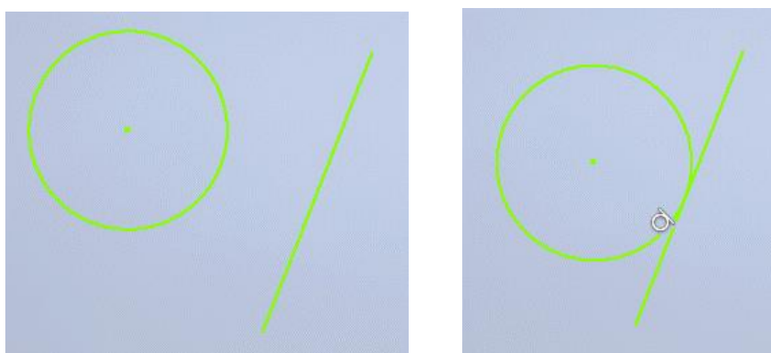
Slika 3.55 Dobivanje tangentski pravca na kružnicu primjenom geometrijskoga ograničenja Tangent
