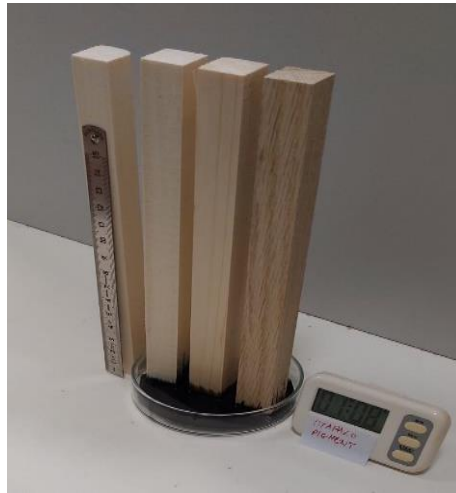
Slika 20. Postavljeni uzorci za ispitivanje brzine i dubine penetracije u uzdužnom smjeru
