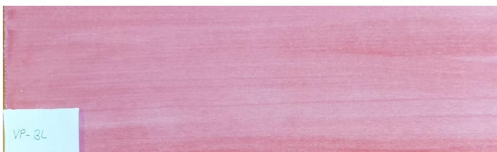
Slika 32. Vodeno močilo s pigmentima (VP) na blanjanjoj površini lipe
