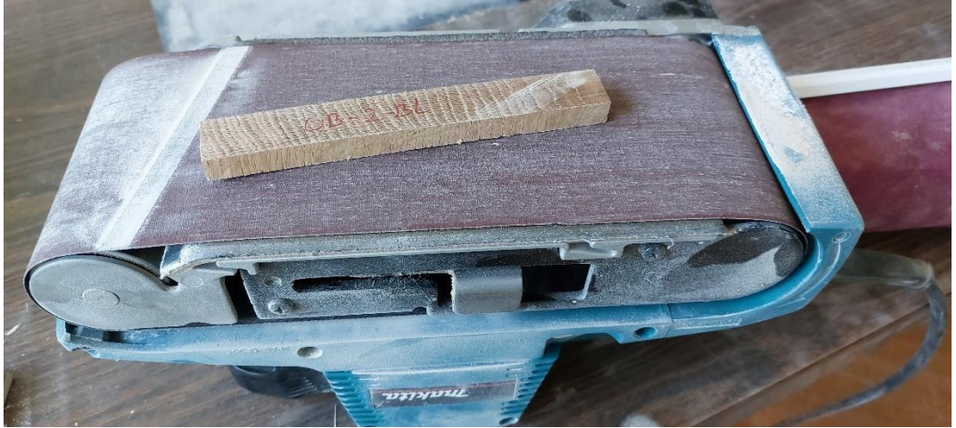
Slika 13. Priprema uzoraka uz pomoću ručne tračne brusilice
