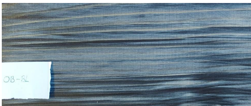
Slika 29. Izgled blanjane površine jelovine premazane otapalnim močilom s bojilima (OP)
