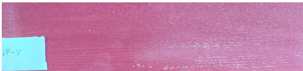
Slika 24. Vodeno močilo s pigmentima (VP) na prethodno navlaženoj hrastovini
