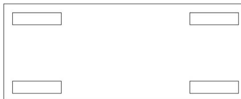
Slika 11. Shematski prikaz mjernih mjesta sjaja na uzorcima
