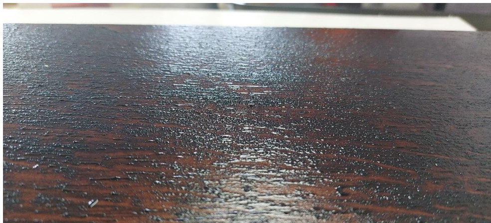
Slika 22. Prikaz izdignutih vlakanaca nakon nanosa vodenog močila s bojilima (VB)
