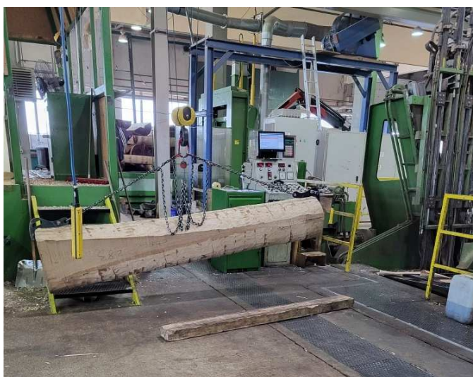
Slika 14. Prijenos sirovine do furnirskog noža (foto: Ivanda., A., 2022.)
