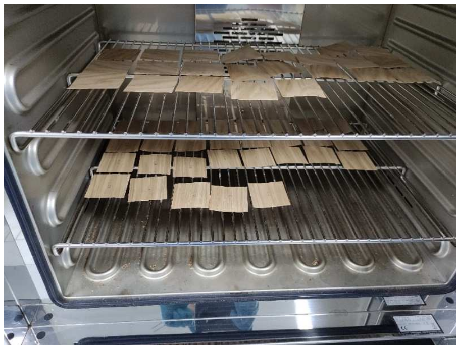
Slika 20. Sušenje uzoraka (foto: Drokan, L., 2022.)
