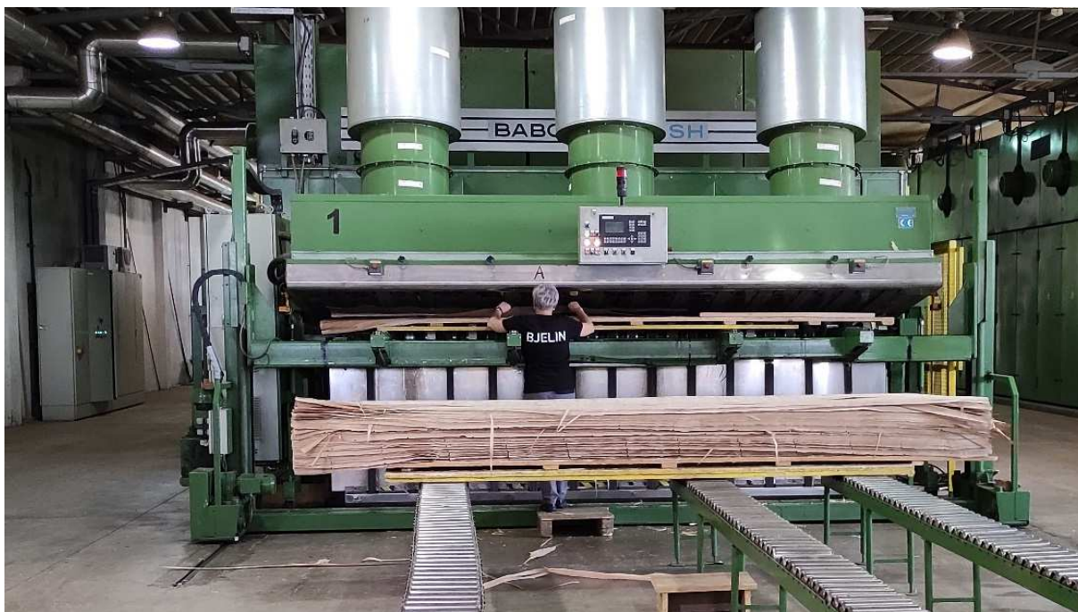
Slika 16. Sušionica za furnire (foto: Drokan, L., 2022.)
