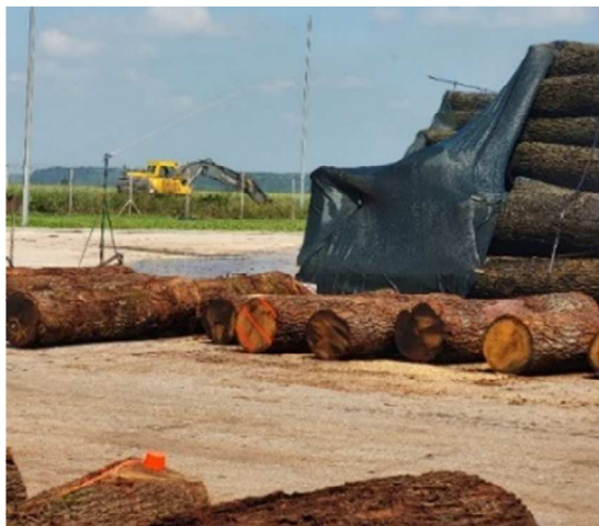
Slika 3. Sustav zaštite trupaca prskanjem (foto: Ivanda, A., 2022.)
