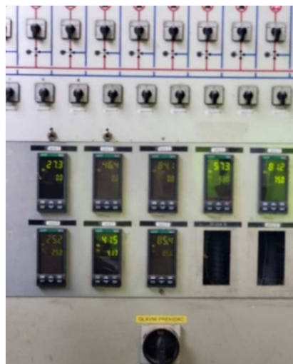
Slika 7. Temperaturna mjerenja trupaca u fazama kuhanja (foto: Ivanda, A., 2022.)
