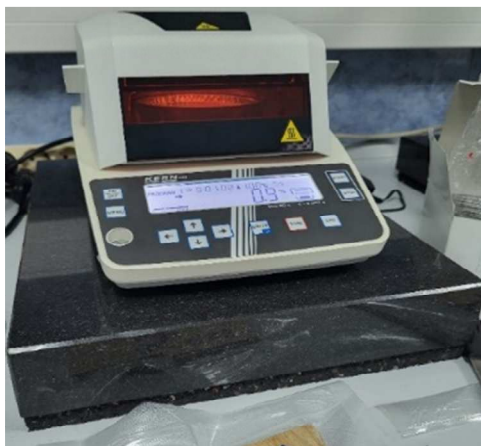
Slika 15. Halogeni vlagomjer u procesu određivanja sadržaja vode uzorka bočnice (foto: Ivanda, A., 2022.)
