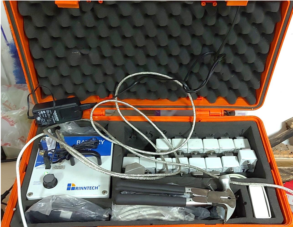
Slika 1. Tomograf s pripadajućim kompletom senzora i priključnim kablovima
