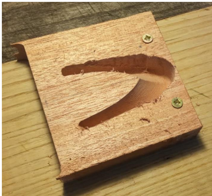
Slika 32. CNC obrađen segment pete vrata
