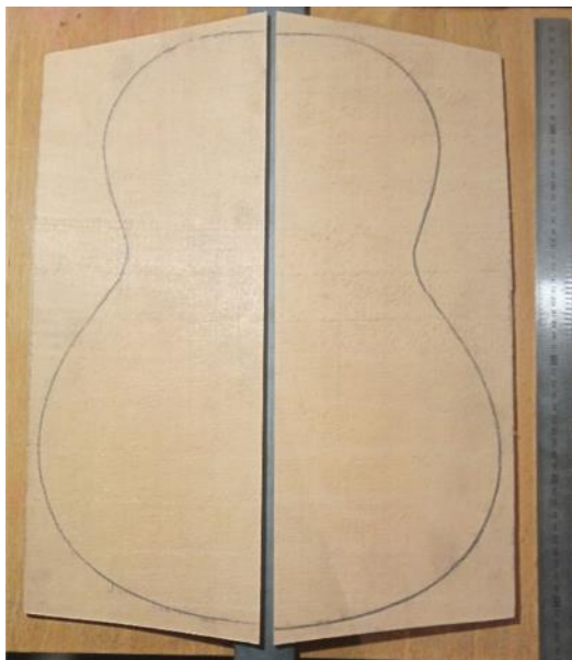
Slika 21. Zvučna ploča prije spajanja
