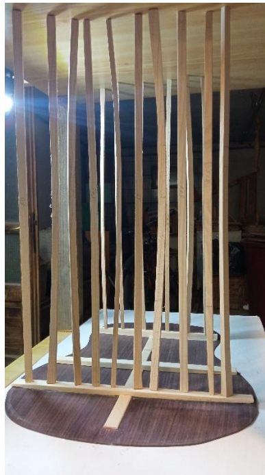
Slika 29. Lijepljenje elemenata ukrute na stražnju ploču gitare
