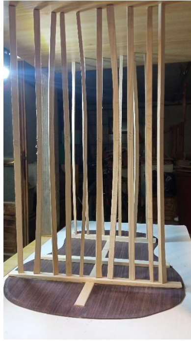
Slika 29. Lijepljenje elemenata ukrute na stražnju ploču gitare
