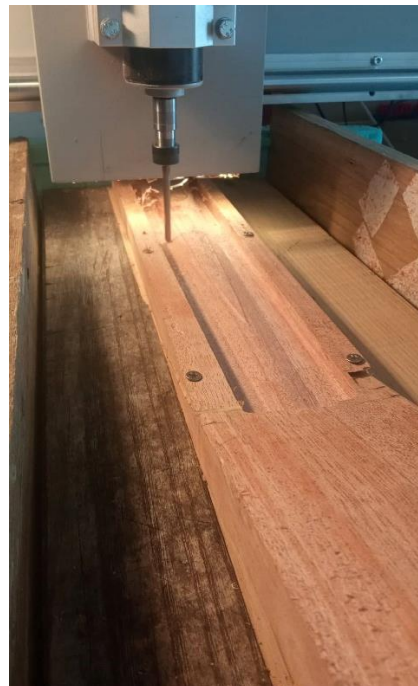
Slika 31. CNC obrada vrata gitare
