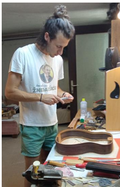
Slika 37. Priprema elemenata gitare prije sklapanja
