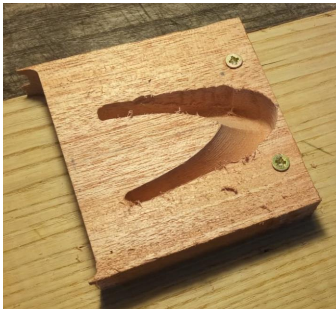
Slika 32. CNC obrađen segment pete vrata
