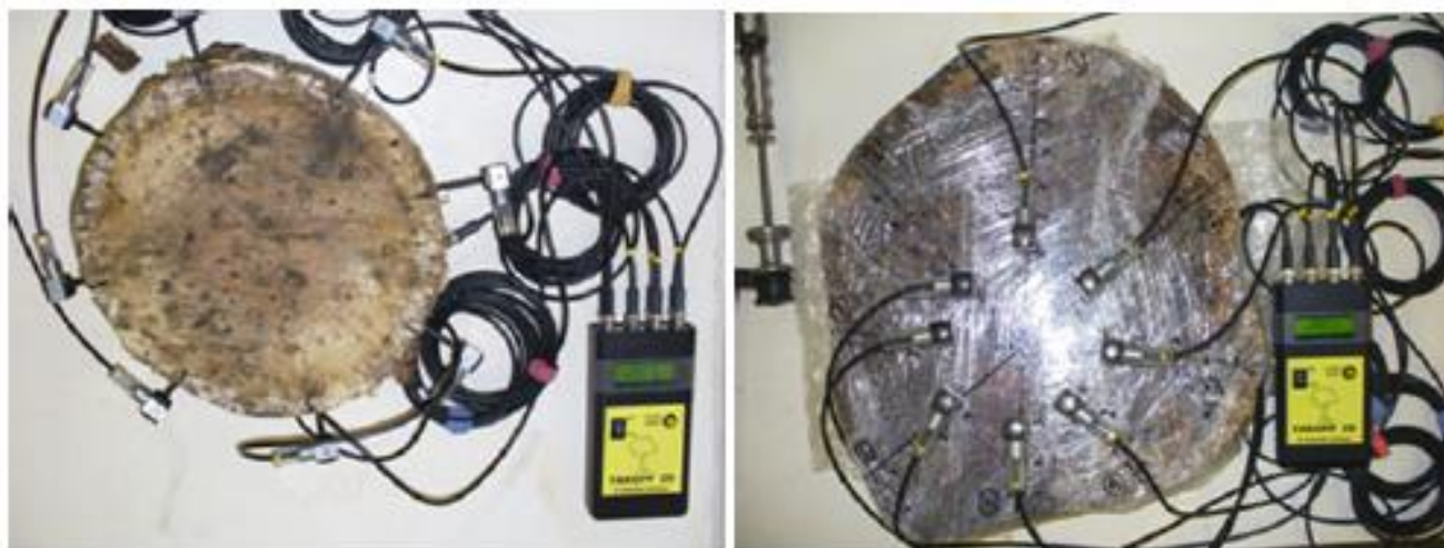
Slika 1. Prikaz pretvornika i pozicioniranja pinova kod ispitivanja u radijalnom smjeru (lijevo) i tangენტnom smjeru (desno), (Bucur, 2011.)
