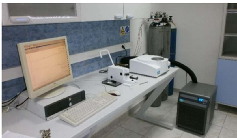
Slika 10. DSC uređaj Perkin Elmer, DSC 6000
