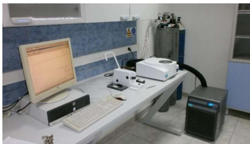
Slika 10. DSC uređaj Perkin Elmer, DSC 6000
