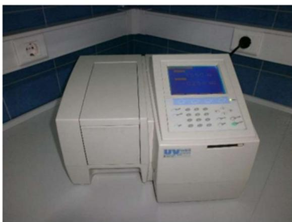
*Slika 9. UV-Vis spektrofotometar Shimadzu UV mini-1240*
