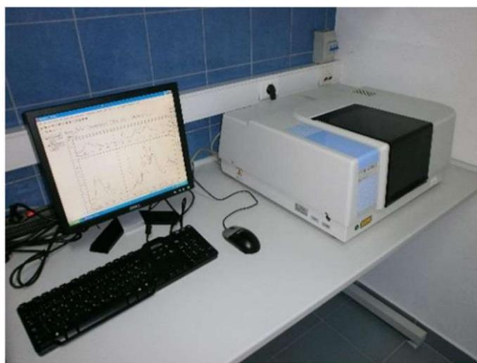
Slika 8. Spektrofotometrijski uređaj Shimadzu tip 8400 S
