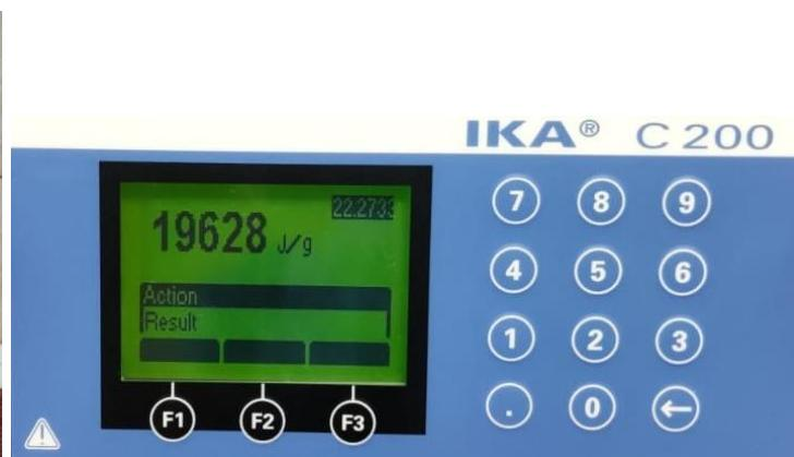
**Slika 24.** Rezultat mjerenja gornje ogrjevne vrijednosti kalorimetrom
