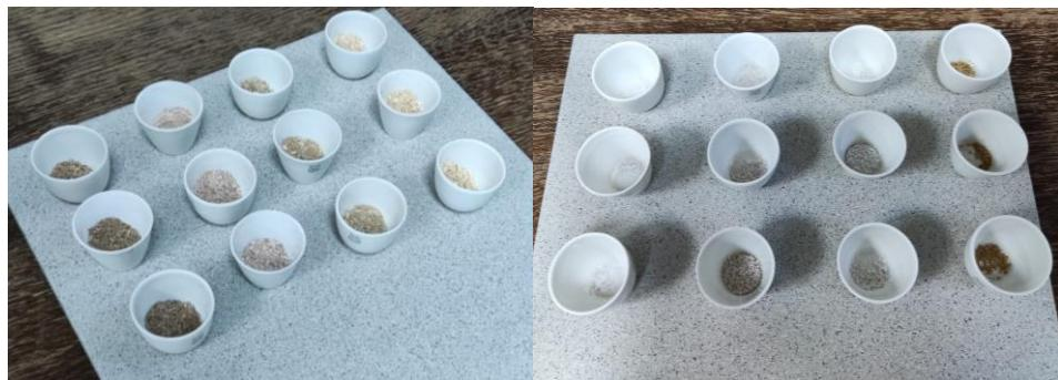
**Slika 19.** Uzorci prije (lijevo) i nakon (desno) spaljivanja
