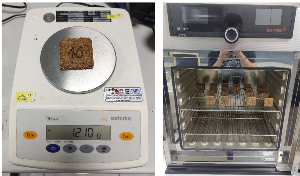
Slika 21. Digitalna precizna vaga i sušionik s uzorcima
