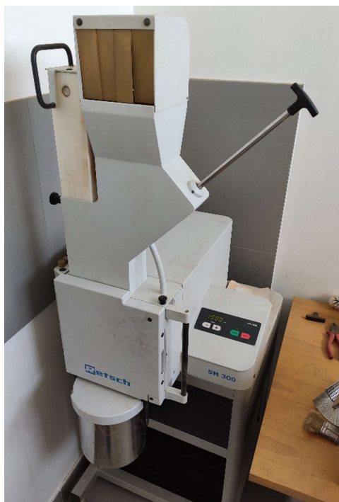
Slika 14. Mlin korišten za dobivanje iverja
