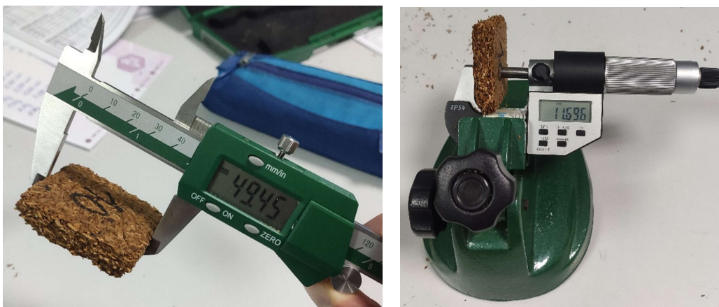
Slika 20. Digitalno pomično mjerilo i digitalni mikrometar
