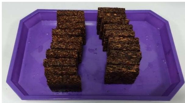
Slika 22. Ocijeđeni uzorci nakon potapanja u vodi
