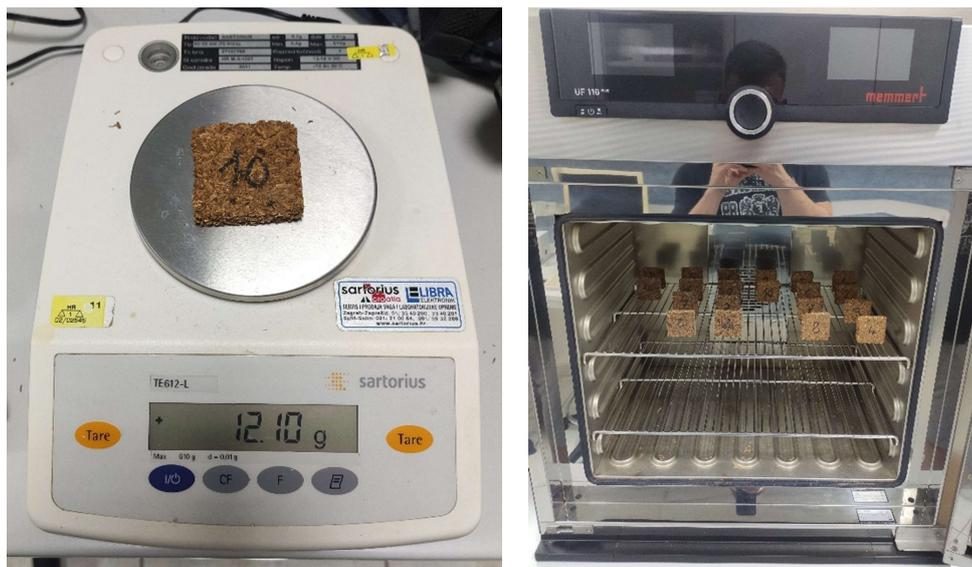
*Slika 21. Digitalna precizna vaga i sušionik s uzorcima*
