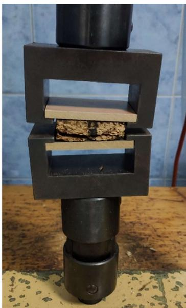
*Slika 25. Uzorak („sendvič“) u hvataljkama uređaja*
