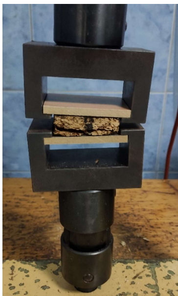
Slika 25. Uzorak („sendvič“) u hvataljkama uređaja
