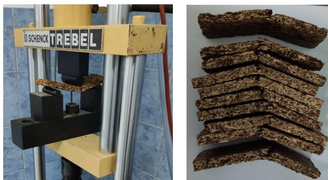
**Slika 24.** Uzorci za vrijeme ispitivanja i nakon ispitivanja
