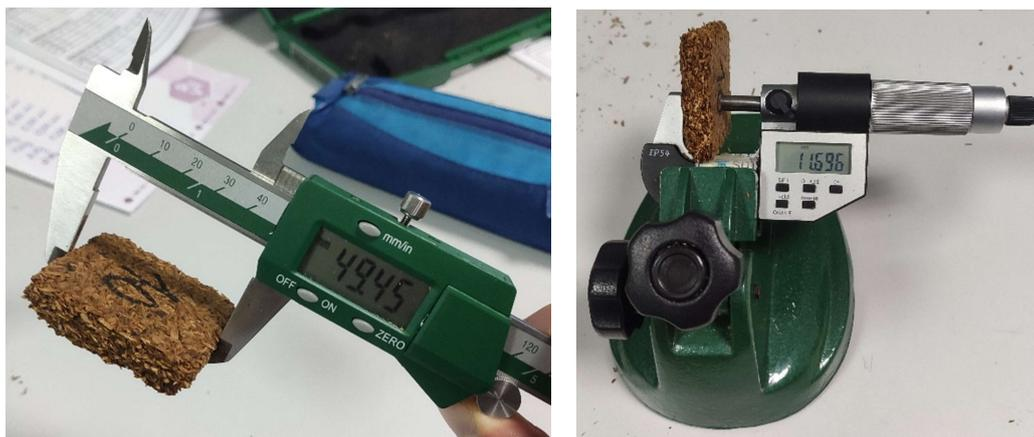
Slika 20. Digitalno pomično mjerilo i digitalni mikrometar
