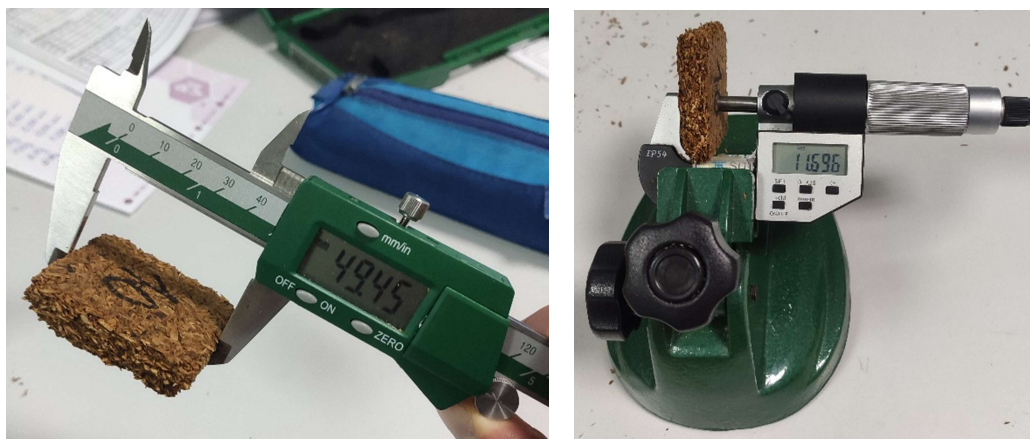
Slika 20. Digitalno pomično mjerilo i digitalni mikrometar
