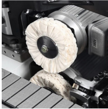
Slika 32. Sustav za poliranje rubova (Izvor: Taco tools https://tacotools.com/products/automatic-edgebender-mx340m-1ph-3ph ; Pristupljeno 19.9.2022.)
