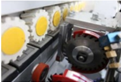
Slika 29. Listovi pile za rezanje na dužinu (Izvor: PT. Alpha Utama Mandiri https://alphautamamandiri.com/nb6ij-auto-inclination-edge-banding-machine/ ; Pristupljeno 5.9.2022.)
