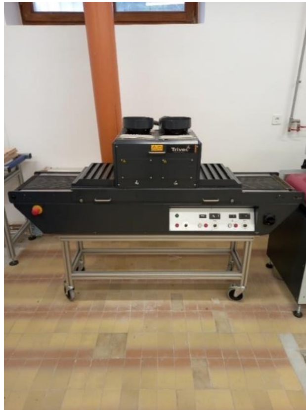
Slika 6. Uređaj za UV sušenje i otvrdnjavanje lakova
