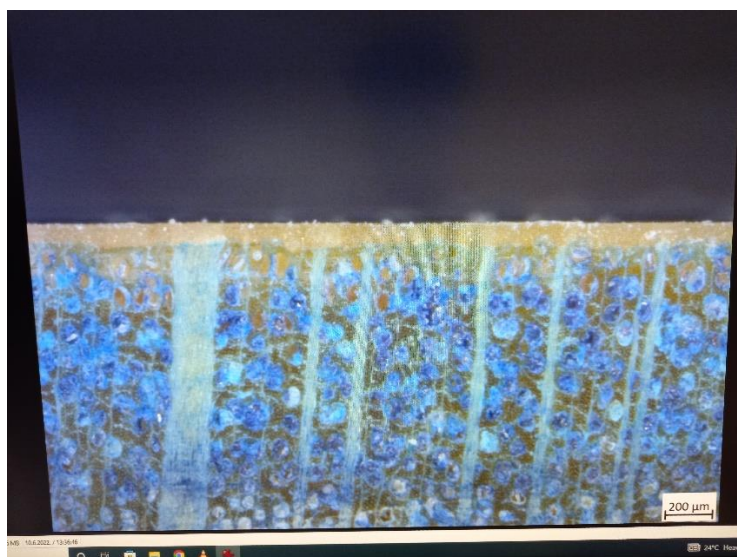
Slika 19. Debljina filma mjerena svjetlosnim mikroskopom
