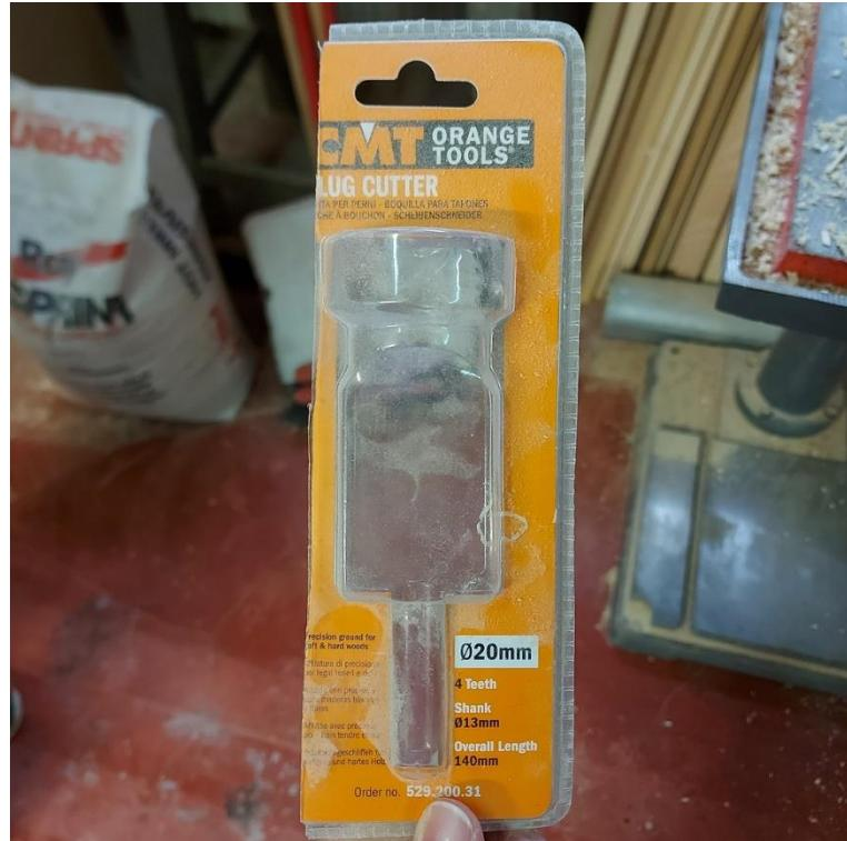
*Slika 13. Svrđlo za izradu čepova (foto: Sabljak M.,2022)*
