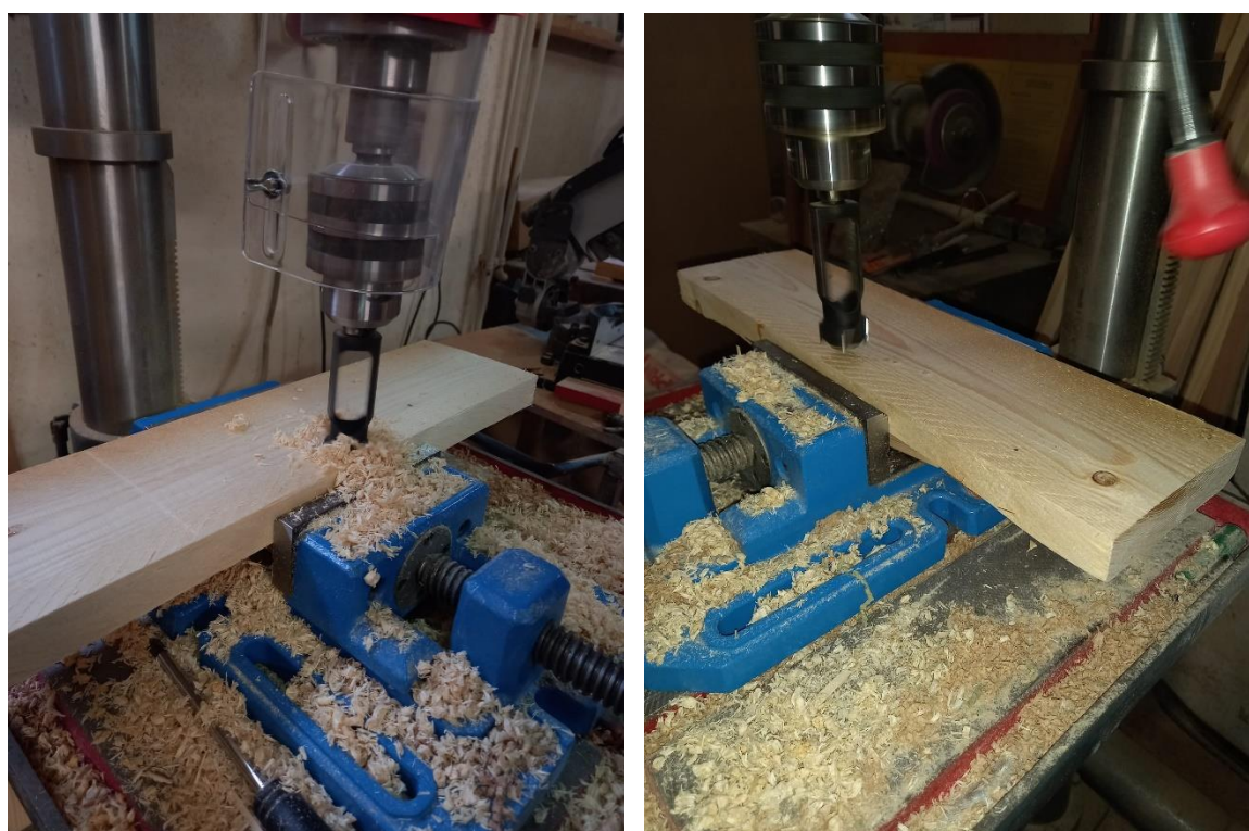
Slika 14. Izrada čepova (foto: Sabljak M.,2022)
