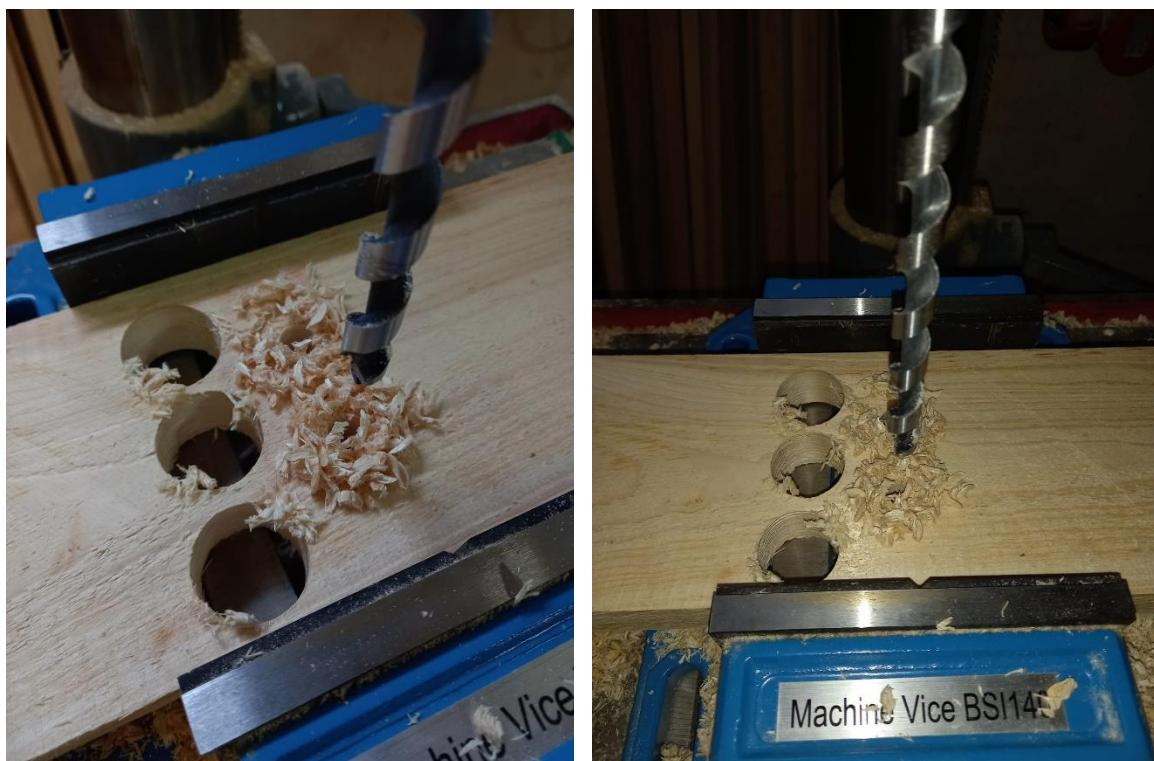
*Slika 16. Izrada uzoraka spiralnim svrdlom (foto: Sabljak M.,2022)*
