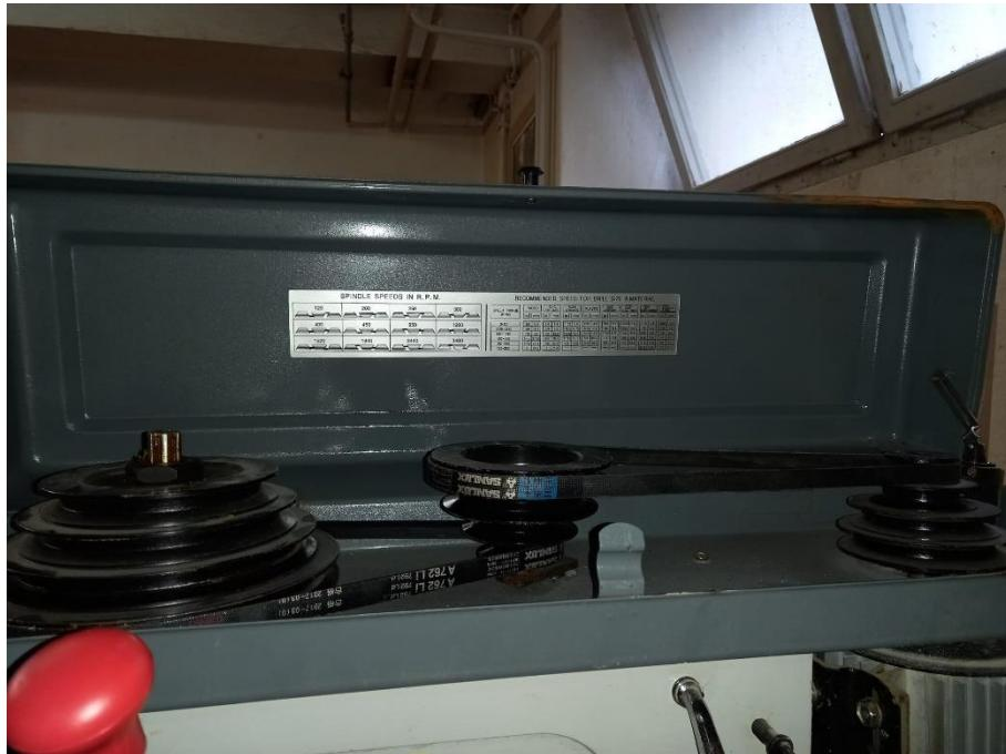
**Slika 11.** Remenski prijenos (foto: Sabljak M., 2022)
