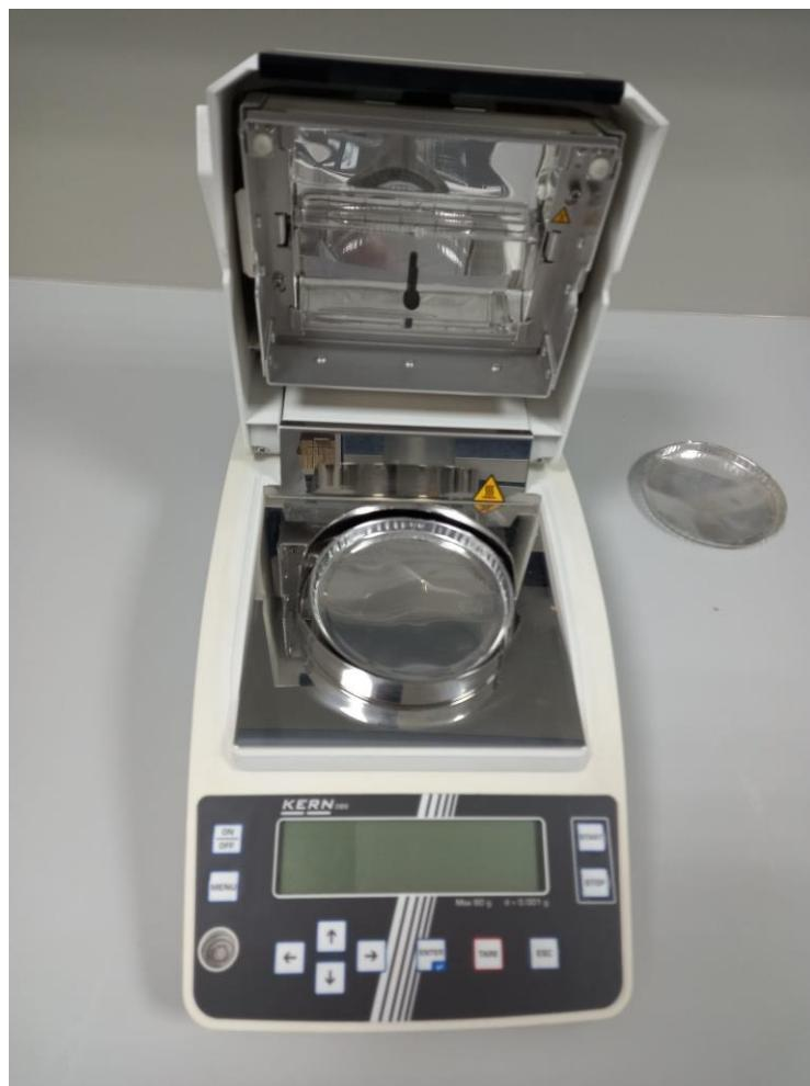
*Slika 3. Halogeni analizator (foto: Sabljak M., 2022)*
