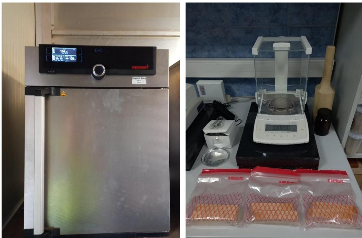
*Slika 4. Sušionik i analitička vaga (foto: Sabljak M.,2022)*
