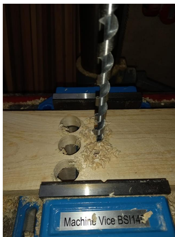
Slika 16. Izrada uzoraka spiralnim svrdlom (foto: Sabljak M.,2022)
