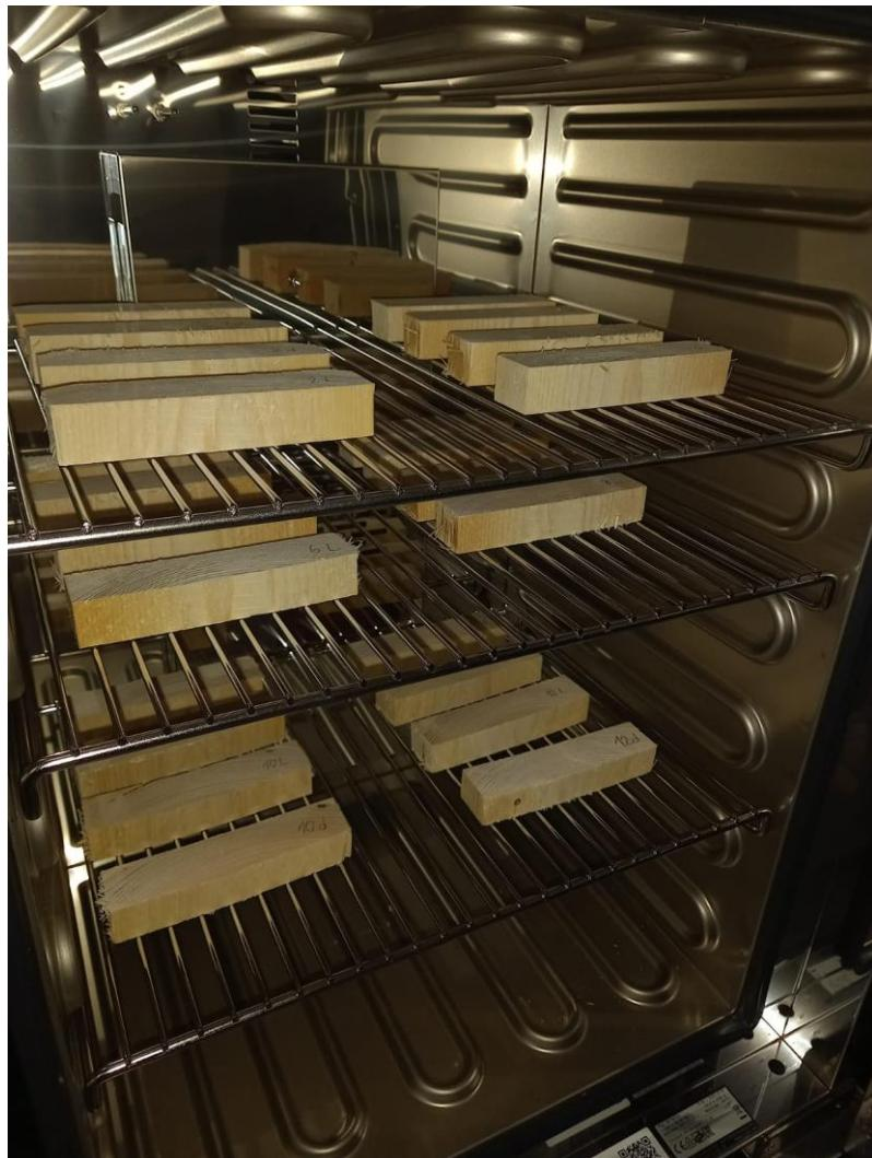
*Slika 23. Sušenje kontrolnih uzoraka (foto: Sabljak M., 2022)*
