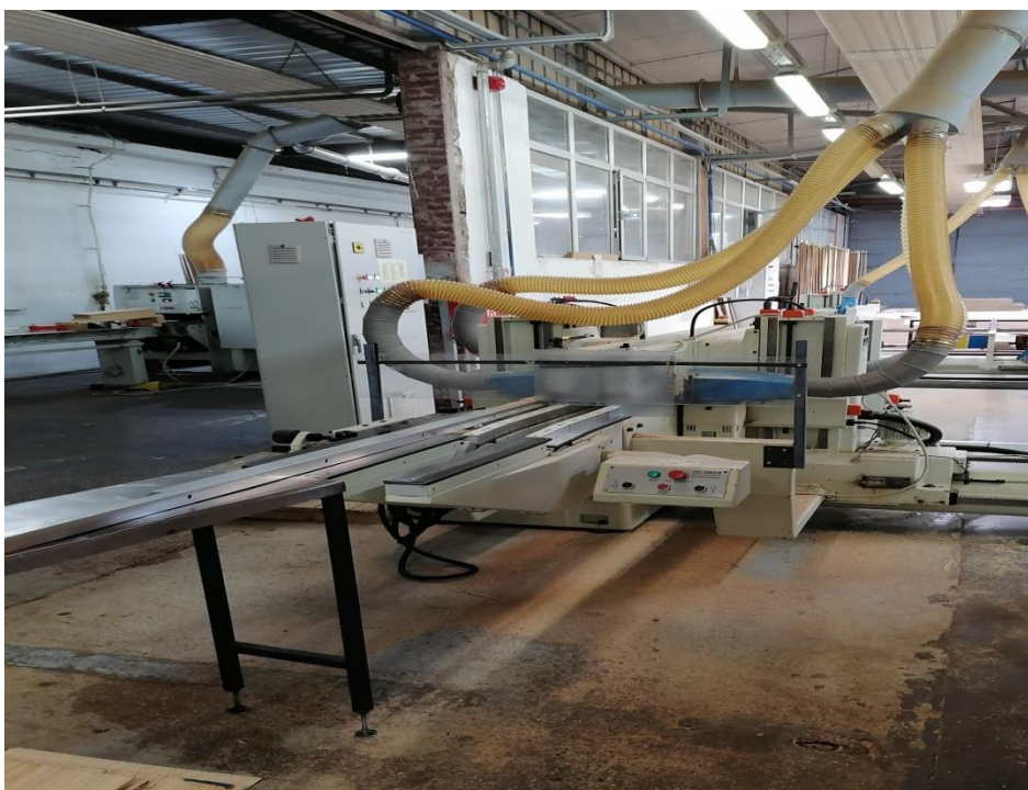
Slika 25. Dvostrani profiler za krojenje na konačnu širinu lamele
