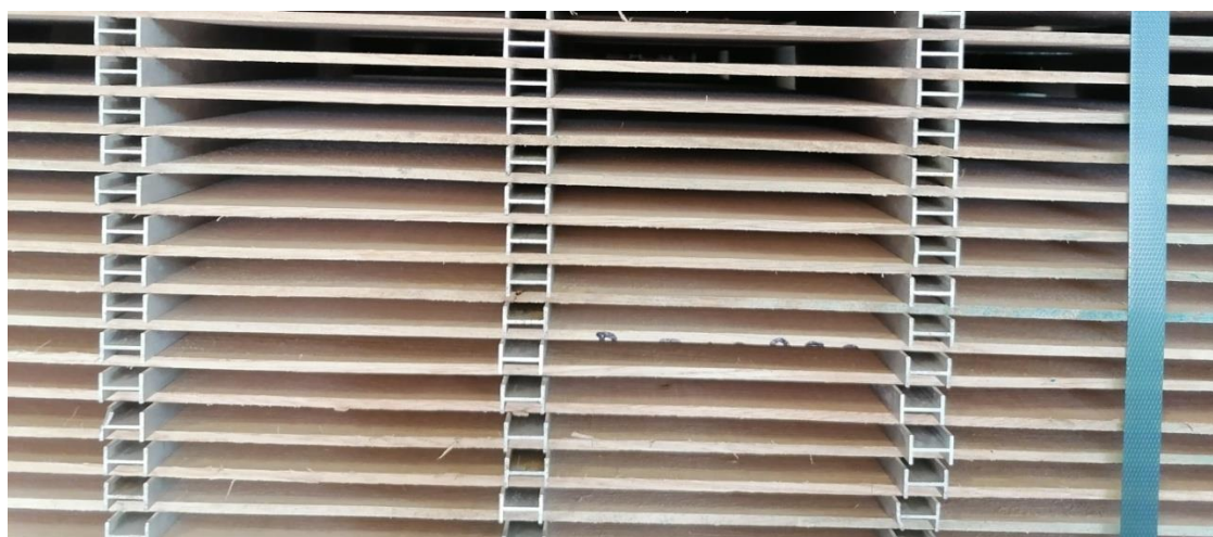
Slika 23. Aluminijske letvice („špangle“) u složaju lamela
