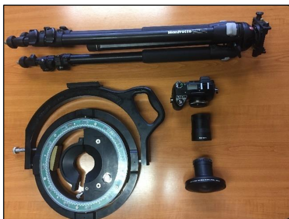
Slika 21. Dijelovi uređaja za snimanje hemisfernih fotografija
