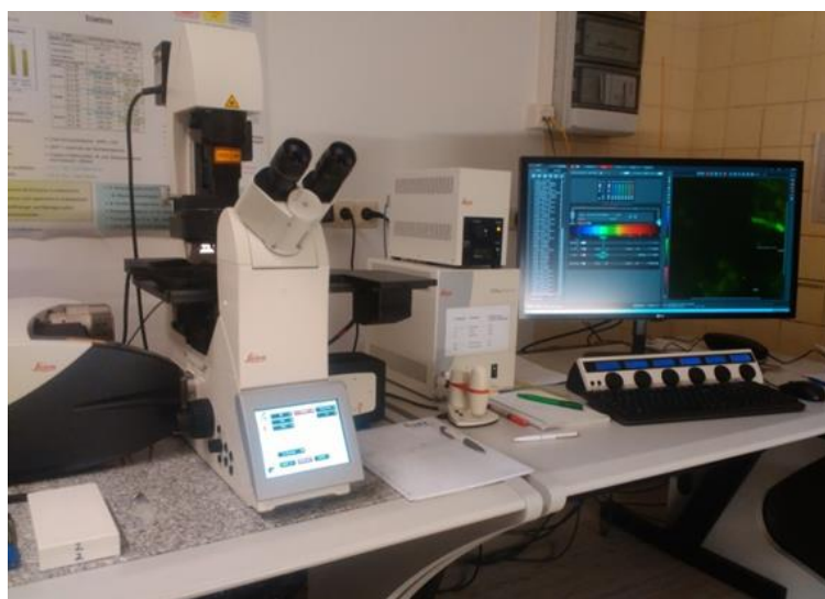
Slika 16. Pregled obrađenih uzoraka pomoću CLSM konfokalnog laserskog pretražnog mikroskopa
