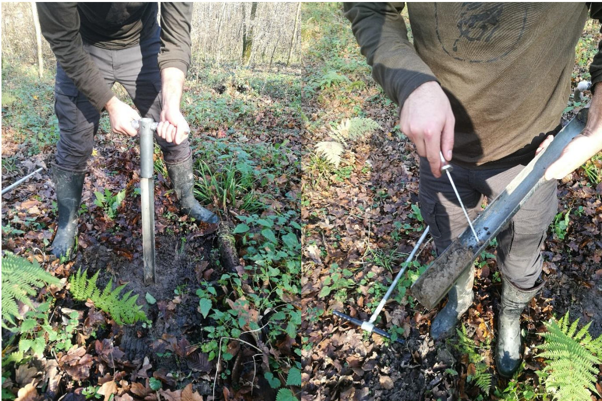
Slika 15. Uzorkovanje tla žljebastom sondom
