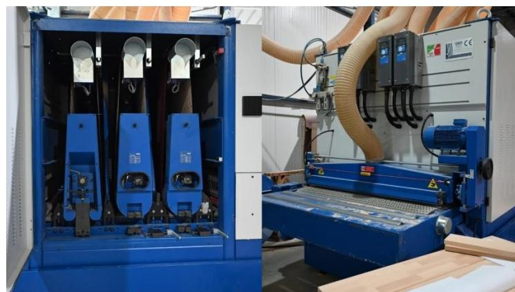
Slika 4. Širokotračna brusilica
