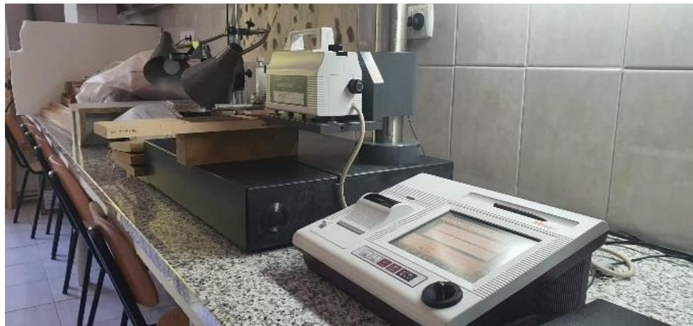
Slika 11. Mjerenje hrapavosti površine uzorka
