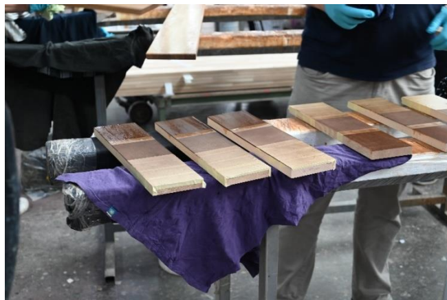
Slika 8. Nanošenje ulja na močenu površinu
