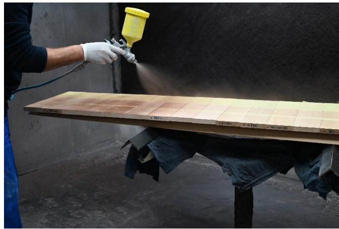
Slika 6. Nanošenje močila zračnim pištoljem
