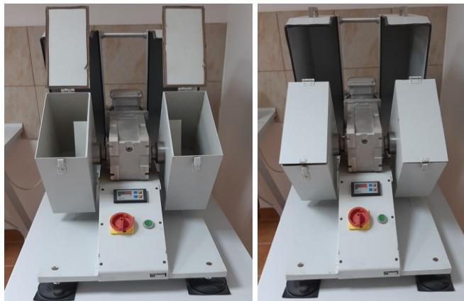
Slika 12. Uređaj za određivanje mehaničke izdržljivosti peleta (pelet-tester)
