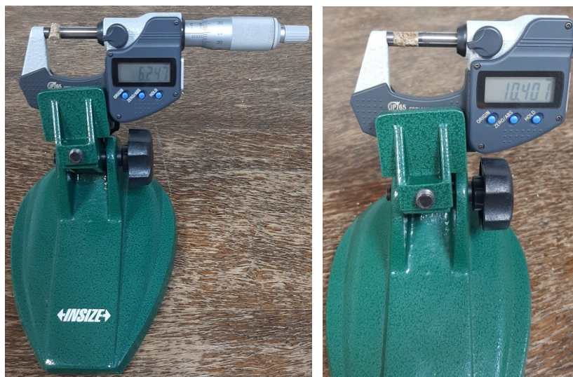
Slika 16. Mjerenje promjera i duljine peleta s mikrometrom
