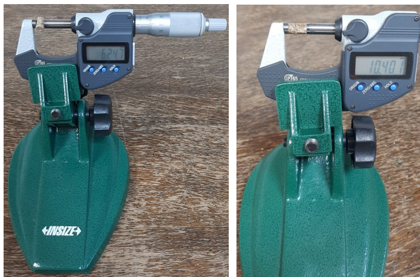
Slika 16. Mjerenje promjera i duljine peleta s mikrometrom
