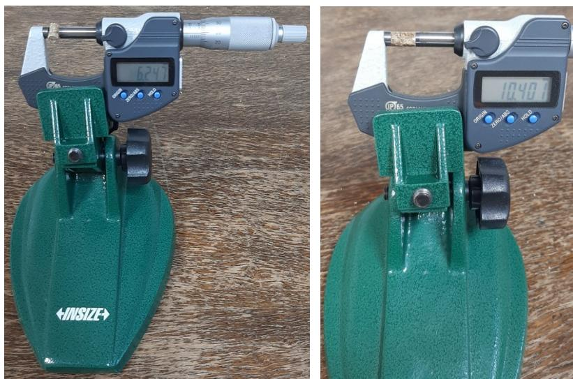
Slika 16. Mjerenje promjera i duljine peleta s mikrometrom
