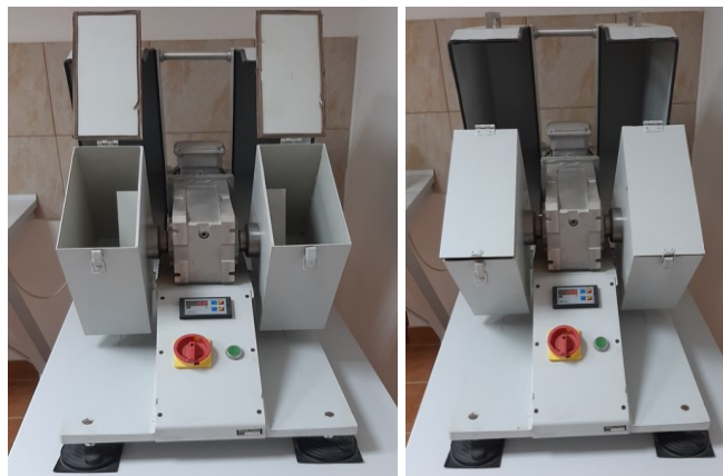
Slika 12. Uređaj za određivanje mehaničke izdržljivosti peleta (pelet-tester)
