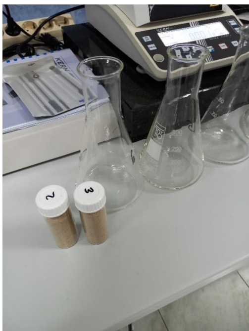
Slika 14. Erlenmeyerova tikvica od 300 mL i uzorci usitnjenog drva koje je potrebno izvagati
