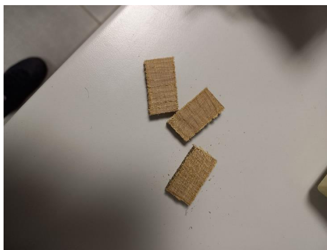
Slika 5. Dobiveni uzorci za ispitivanje cjelovitog drva
