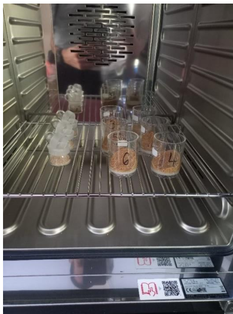
Slika 12. Uzorci na sušenju u laboratorijskom sušioniku
