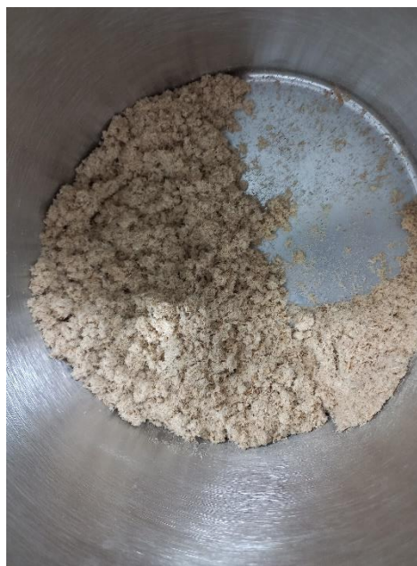
Slika 11. Uzorci za ispitivanje usitnjenog drva (usitnjeni uzorak granulacijom 0,5 mm)
