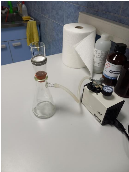
Slika 20. Aparatura za filtraciju
