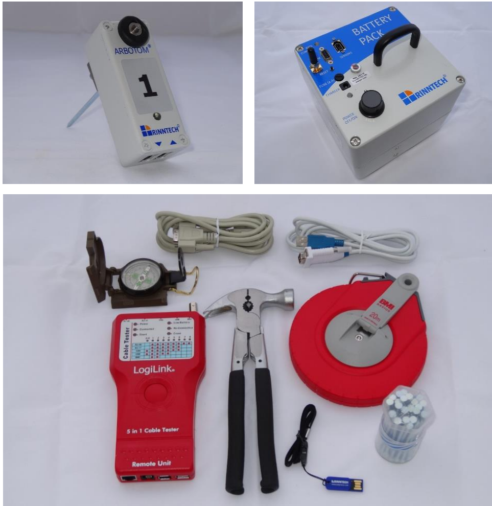
Slika 10. Fotografije dijelova tomografa
