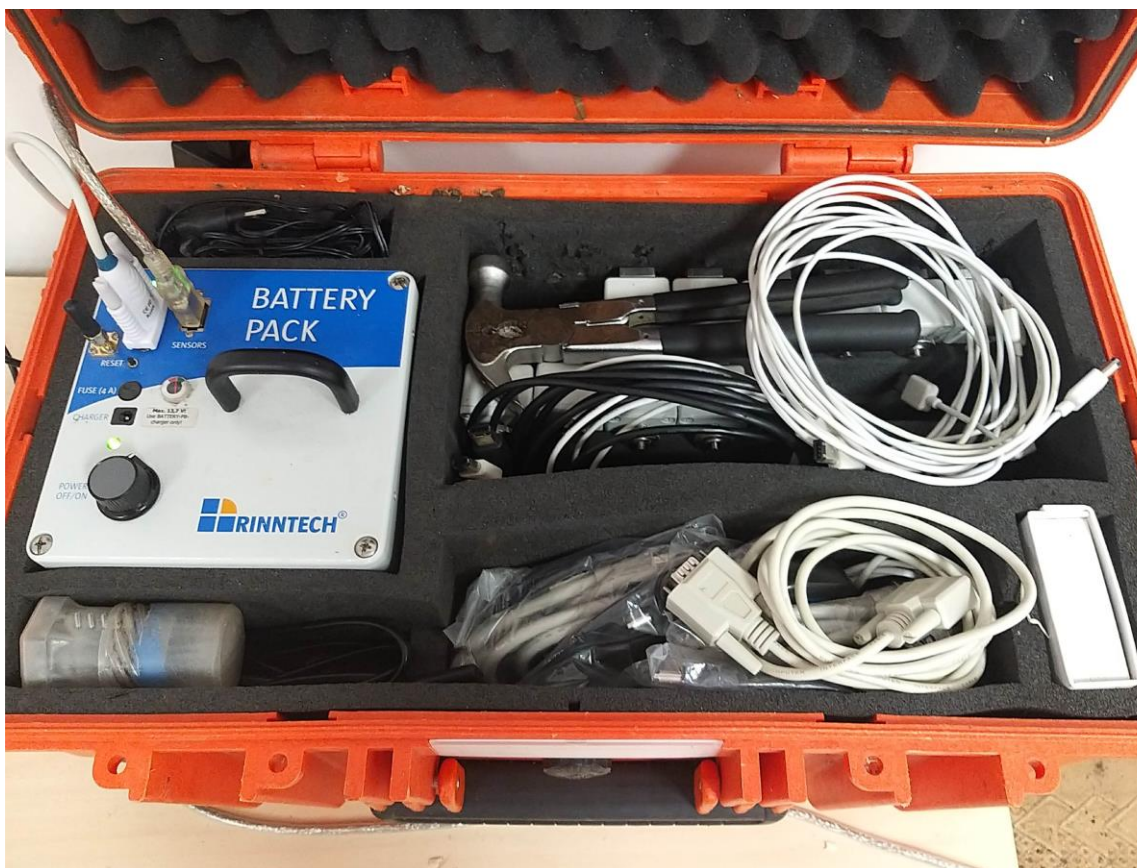
Slika 9. Zvučni tomograf RINNTECH Arbotom – Scientific 2D/3D s oprem
