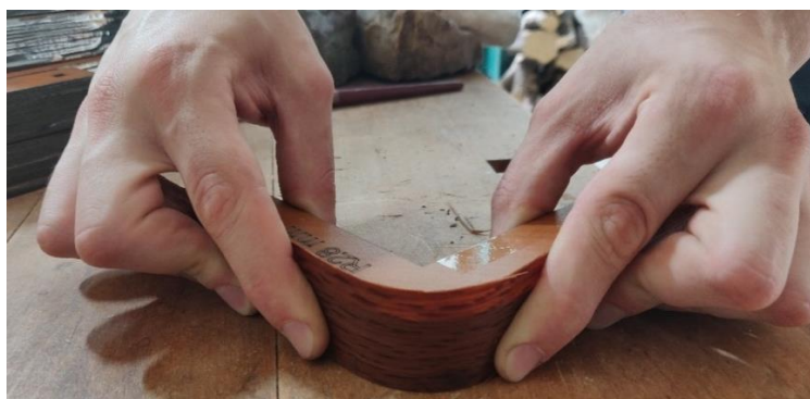
Slika 43: Potpuno savinuti pareni uzorak prema opisanoj metodi (fotografija: Rocco, 2022.)
