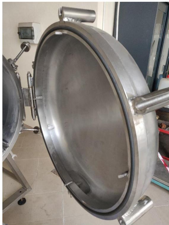
**Slika 8:** Okrugla vrata kotla s gumenom
