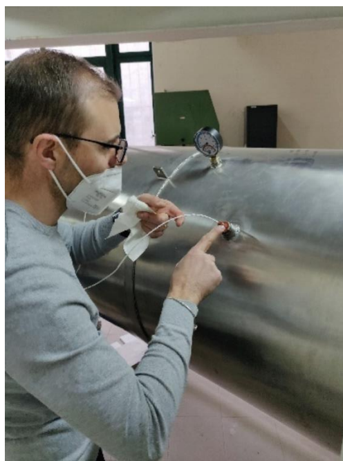
Slika 15: Ugradnja termoparova (fotografija: Kvakon, 2022.)
