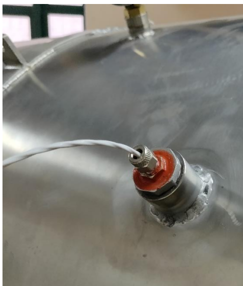
Slika 16: Ugrađen i zabrtvljen termopar (fotografija: Kvakon, 2022.)
