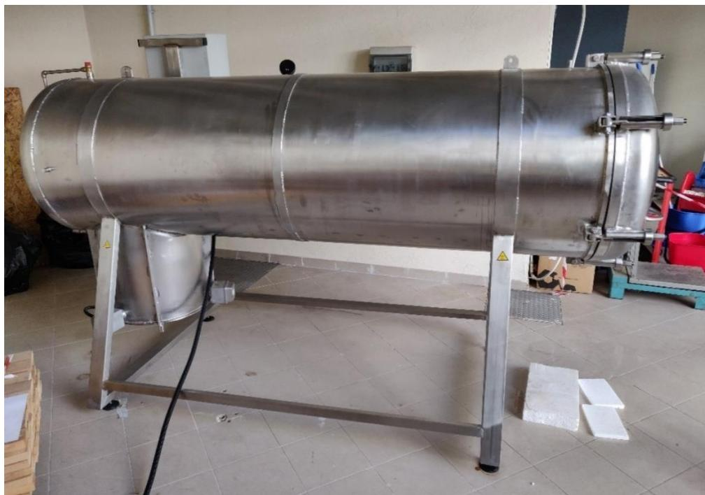
**Slika 5:** Kotao za parenje pod tlakom
