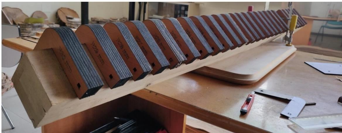
**Slika 34:** Sortiranje kalupa prema radijusu
