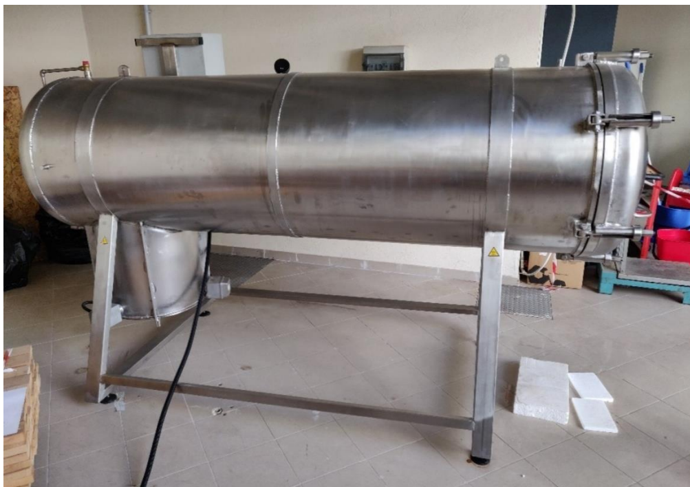
Slika 5: Kotao za parenje pod tlakom (fotografija: Kvakana, 2022.)
