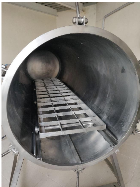
Slika 9: Kolica za građu (fotografija: Kvakan, 2022.)
