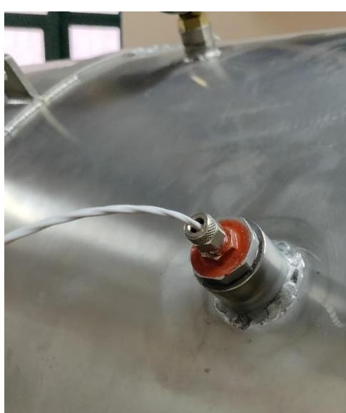
*Slika 16: Ugrađen i zabrtvljen termopar
