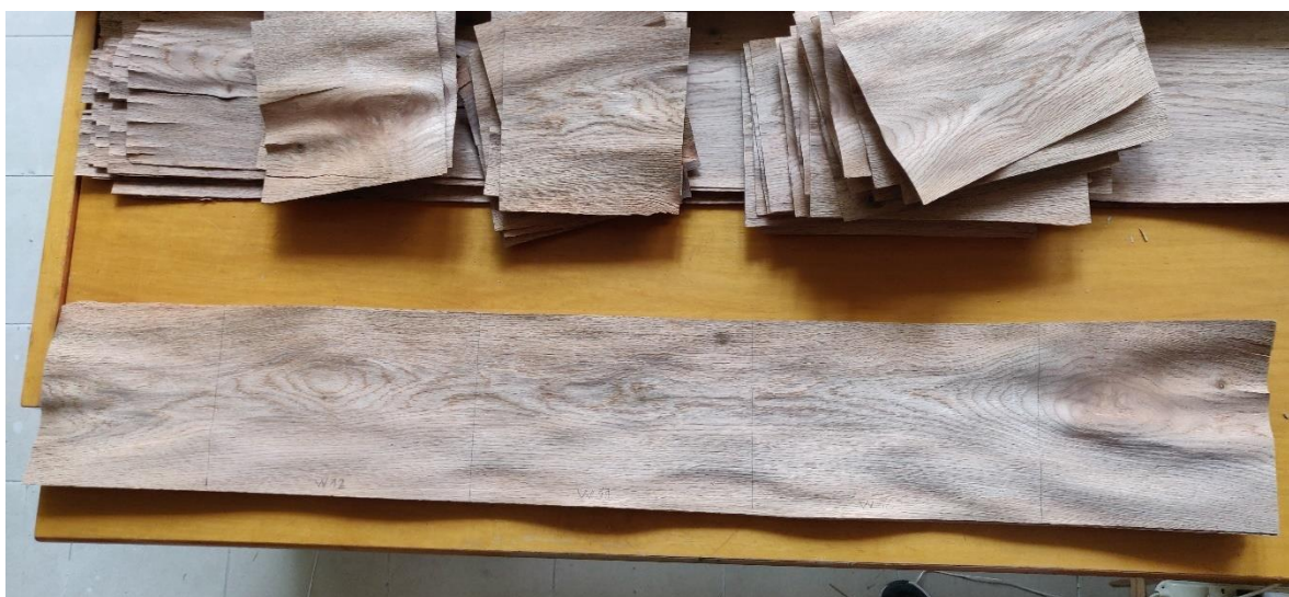
Slika 23: Izrezivanje uzoraka izbjegavajući greške (fotografija: Kvakana, 2022.)
