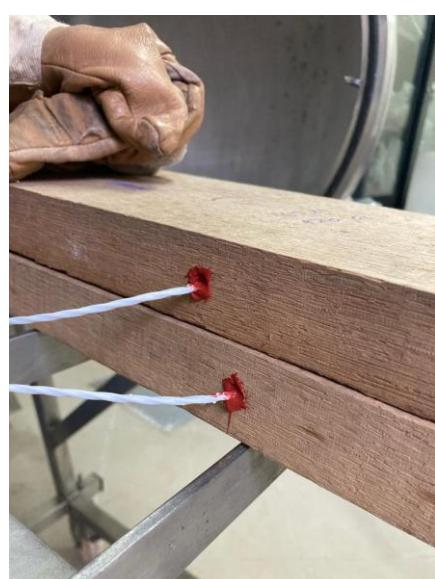
*Slika 17: Testiranje termoparova
