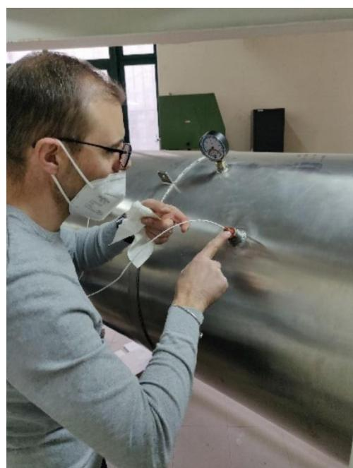
*Slika 15: Ugradnja termoparova
