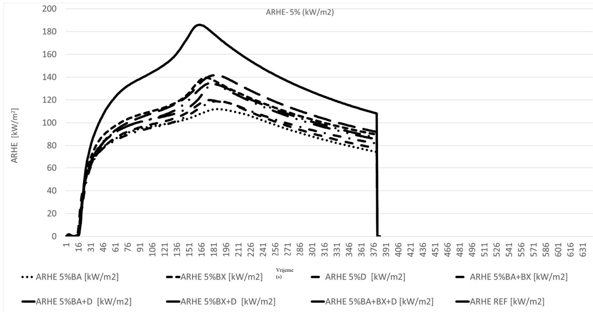
Slika 45. Grafički prikaz iznosa ARHE (prosječna brzina emisije topline) u kW/m 2 za vrijeme ispitivanja uzoraka s 5 % koncentracijom izmjerenih konusnim kalorimetrom
