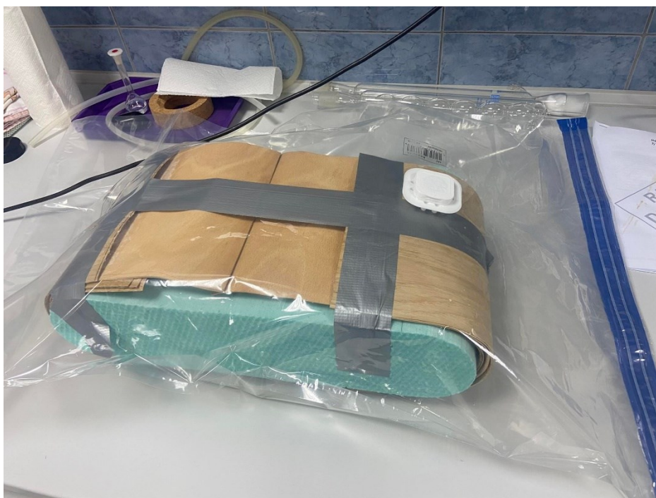
Slika 22. Prikaz vakuumiranja furnira.
