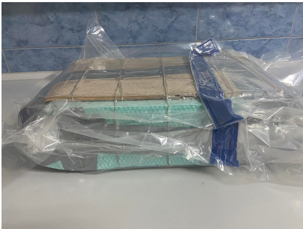
Slika 23. Prikaz vakuumiranja furnira.
