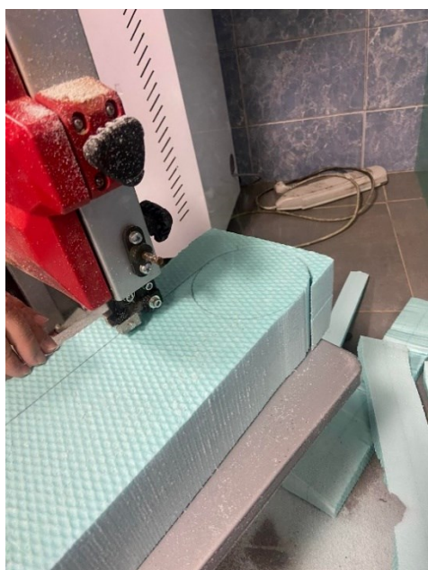
Slika 19. Prikaz piljenja šablone na tračnoj pili.
