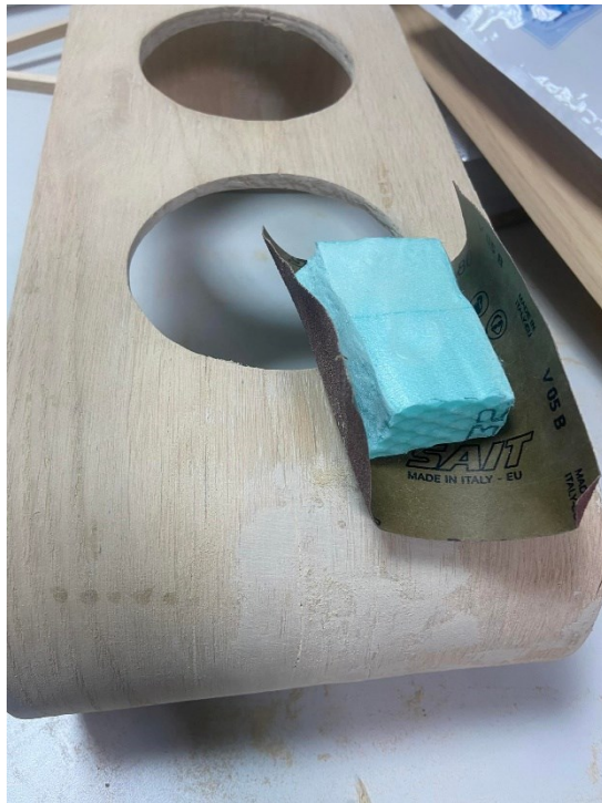
Slika 25. Prikaz brušenja nepravilnosti.
