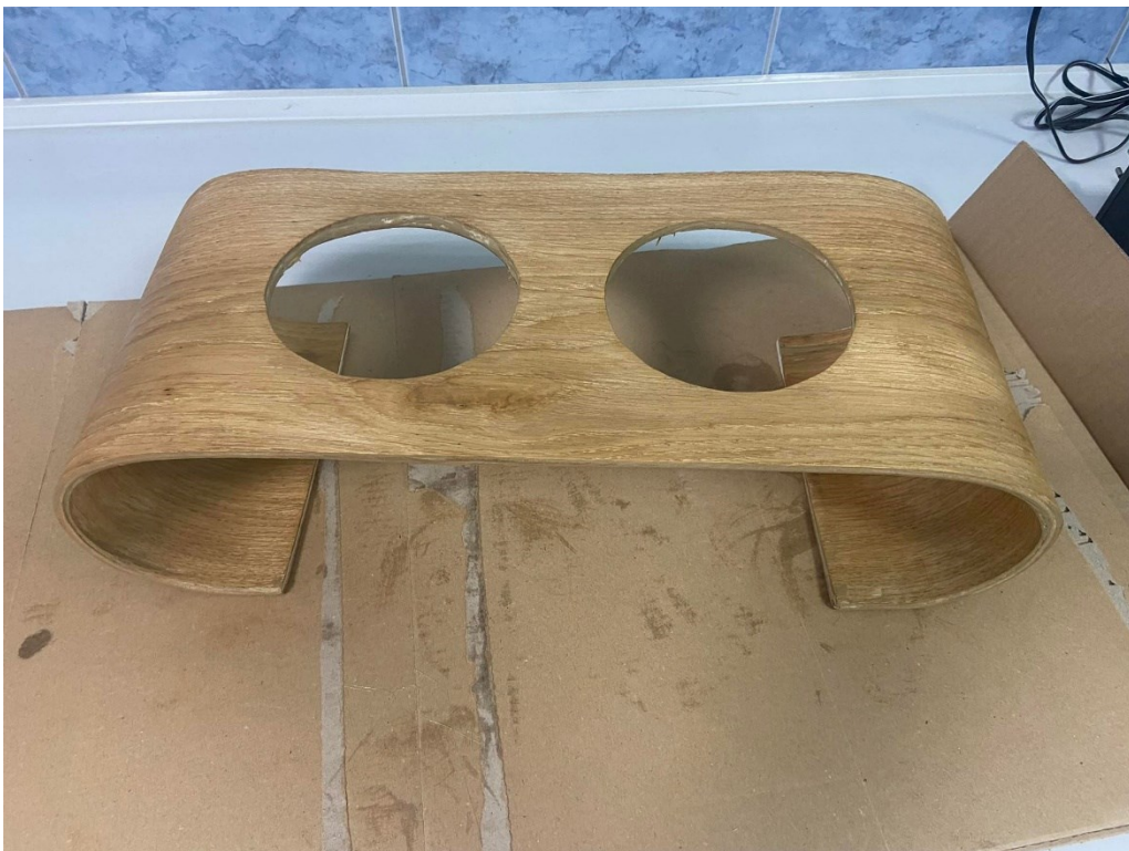
Slika 26. Prikaz prvog sloja uljnog premaza.
