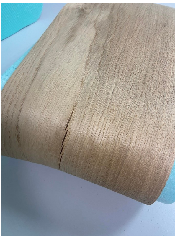
Slika 21. Prikaz pukotine nastale sušenjem (zatezanjem) furnira.
