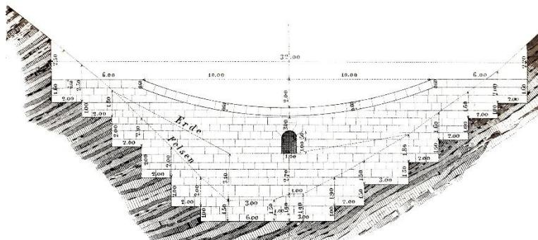
Slika 26. Konsolidacijska pregrada s ispustom za vodu pri vrhu pregrade (Izvor: Demontzey 1880)
