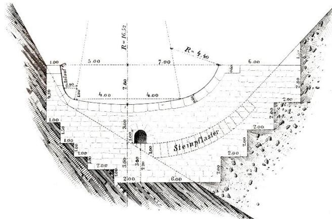
**Slika 28.** Konsolidacijska pregrada u usjeku ( Izvor: Demontzey 1880)
