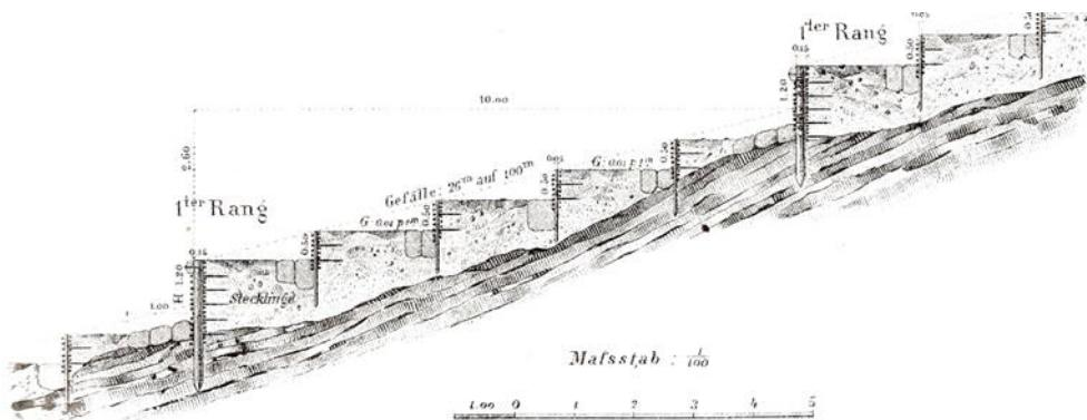
Slika 9. Sanacija erodibilnog terena podizanjem terasa (Izvor: Demontzey 1880)
