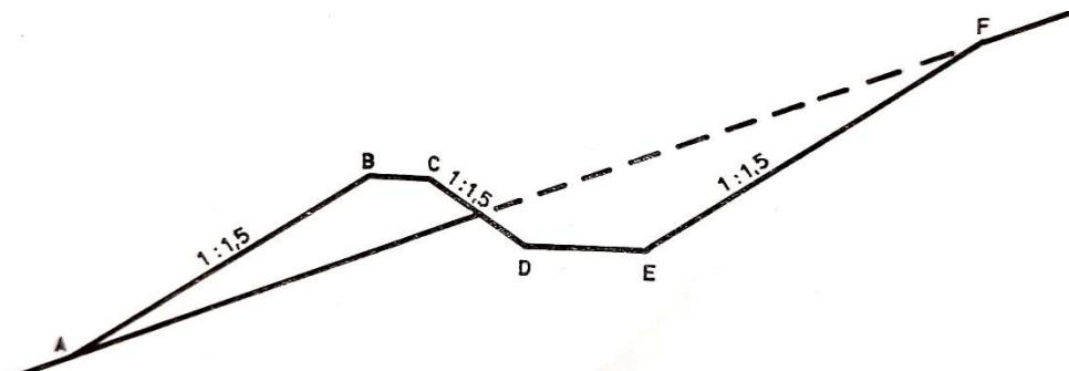
*Slika 10. Shematski prikaz poprečnog presjeka konturnog rova (Izvor: Lukić 1973)*
