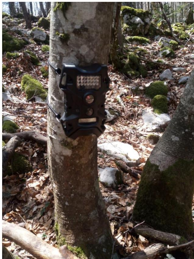
Slika 32. Foto-senzorna kamera postavljena i fiksirana na pogodno stablo prilikom ovog istraživanja
