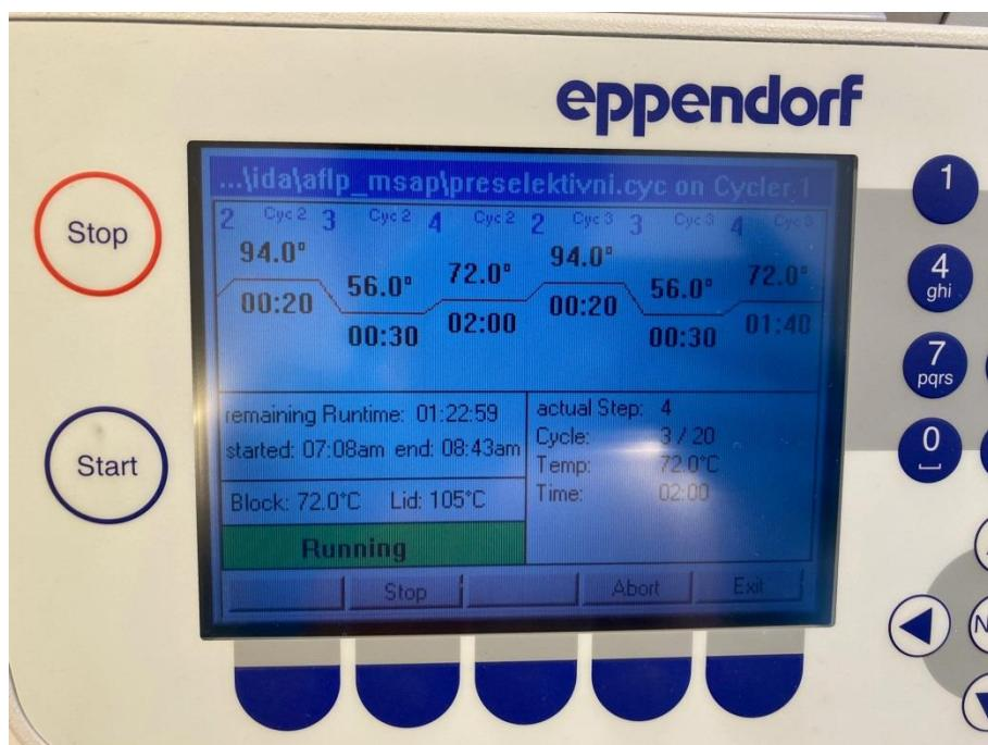
Slika 30. PCR program za preselektivnu amplifikaciju na uređaju Mastercycler EP Gradient (Eppendorf AG).
