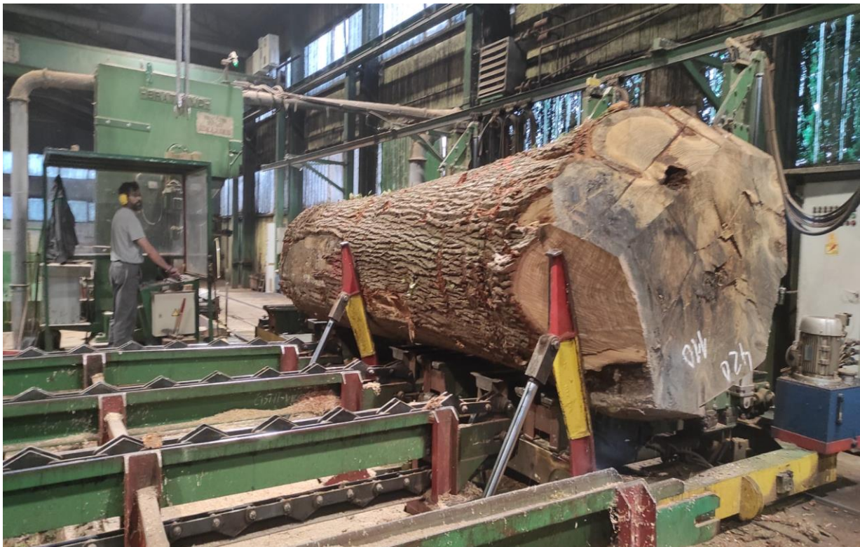
Slika 2 Tračna pila trupčara BRATSTVO TA-1400 (foto: Krznarić I., 2023.)
