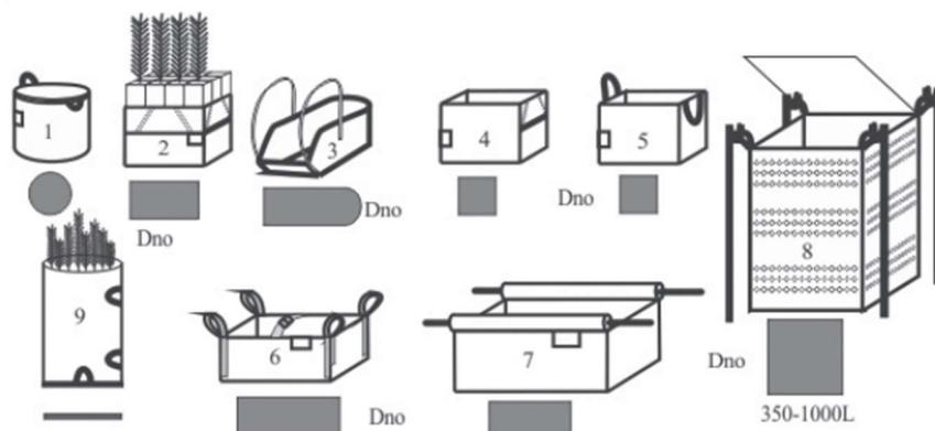
Slika 9. Shematski prikazi različitih oblika kontejnera i dna kontejnera za transport sadnica kod pošumljavanja i umjetne obnove sastojina sadnjom sadnica
