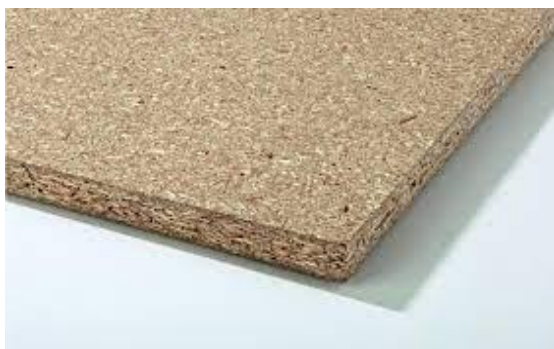
Slika 1. Ne-oplemenjena ploča iverica
