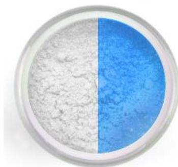
Slika 15. Primjer pigmenta za UV otvrđnjivanje (Luminochem, 2023)
