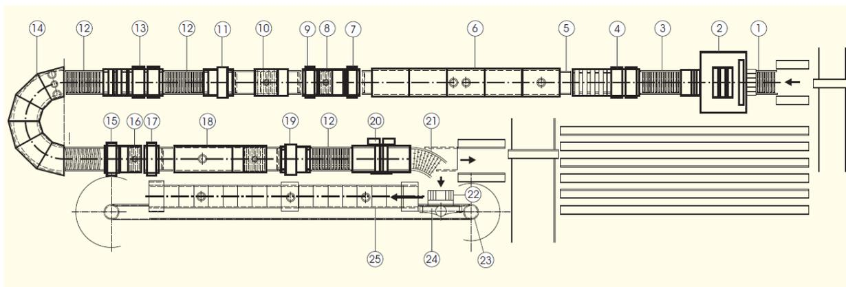
Slika 35. UV otvrdnjivanje pločastih elemenata za namještaj UV osnovnim i pokrivnim premazom(Jaić i drugi, 2000)
