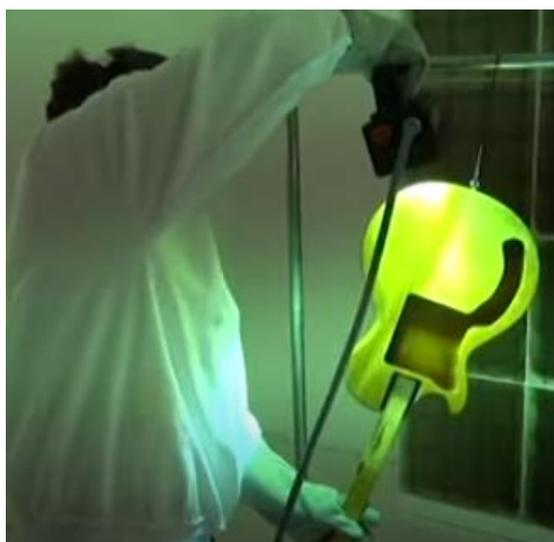
Slika 55. Otvrdnjivanje drvene površine UV sijalicom (YouTube, 2013)
