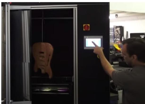
Slika 49. Komora za UV otvrđnjivanje (Cureuv.com, 2023).
