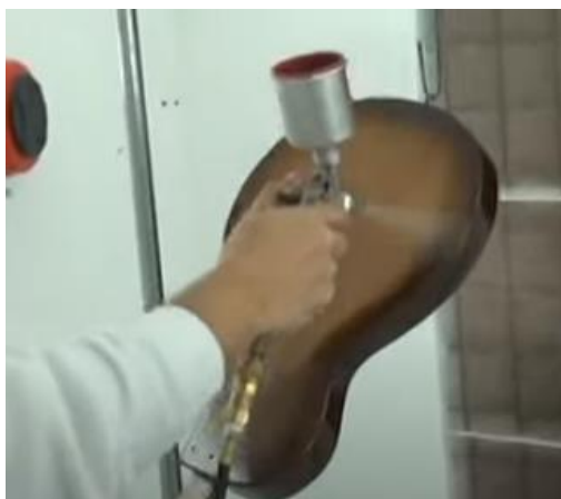
Slika 58. Nanošenje završne površine UV prskanjem (YouTube, 2013)
