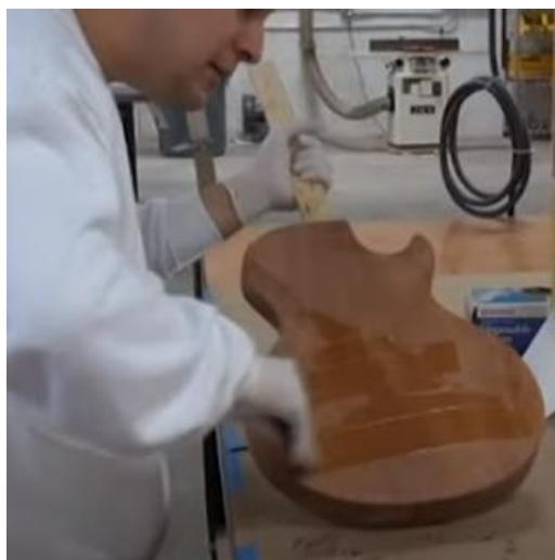
Slika 52. Nanos ulja na drvenu površinu (YouTube, 2013)
