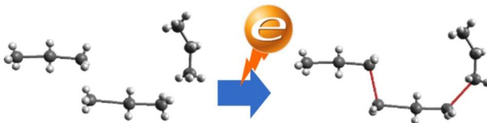
Slika 6. Princip otvrdnjivanja elektronskim zračenjem (NHV Corporation)
