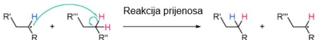
Slika 22. Prijenos polimernog lančanog sustava (Ribas-Massonis i drugi, 2022)
