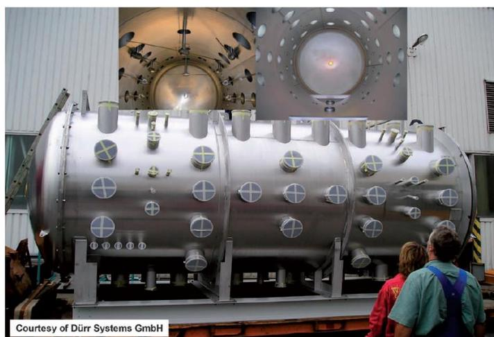
Slika 42. Komora za otvrdnjivanje UV plazmom (Schwalm, 2006)
