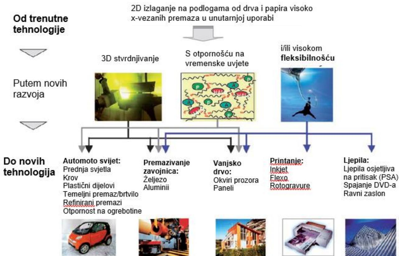
Slika 47. Područje primjene UV otvrdnjivajućih premaza (Schwalm, 2006)
