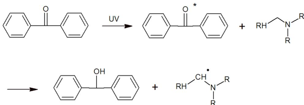
Slika 18. Stvaranje radikala izlučivanjem vodika (Polymerdatabase, 2023)
