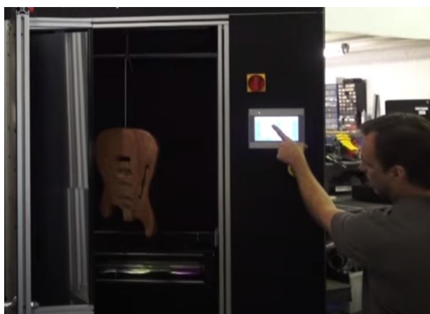
Slika 49. Komora za UV otvrđnjivanje (Cureuv.com, 2023).
