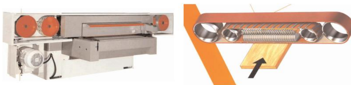
Slika 8. Automatska uskotračna brusilica (Jaić i Živanović-Trbojević, 2000)
